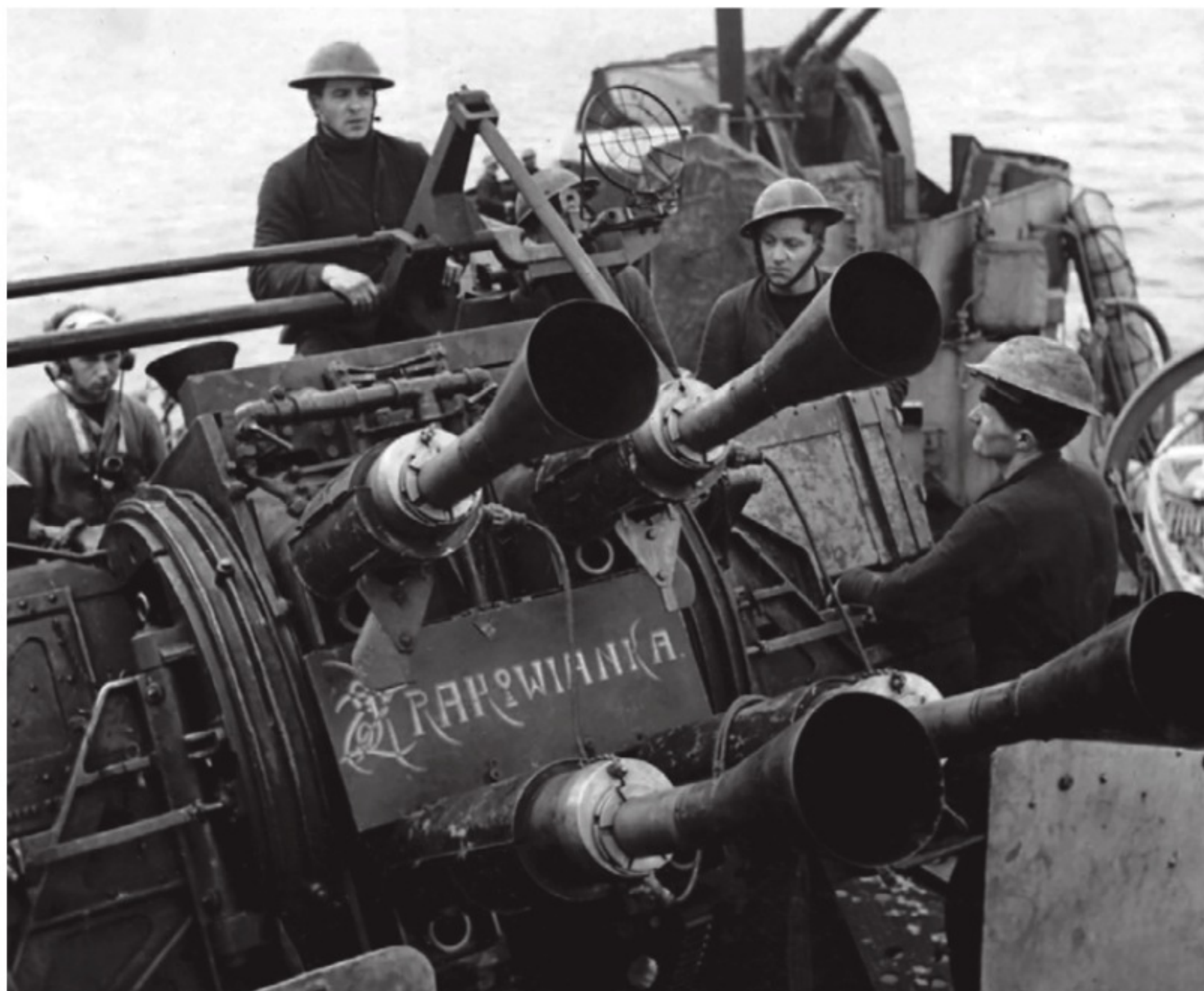
▲ Un affut quadruple antiaérien QF 2-Pdr Mk VIII Pom-pom et ses servants à bord du Krakowiak . Chacun des tubes peut tirer en une minute 115 projectiles d'un calibre de 40 mm. Wirtualne Muzeum Kresy-Syberia
