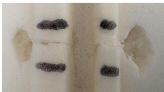
Imagen 63: Detalle hendiduras de fijación esterilla en relleno de Foam asiento SPORT. Adaptación de relleno asiento sport para que pueda albergar esterilla asiento NORMAL
