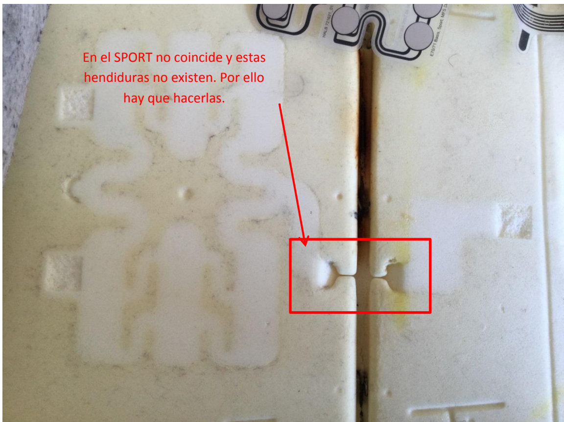
Imagen 59: Verificación del tipo de sujeción de esterilla al relleno del asiento
