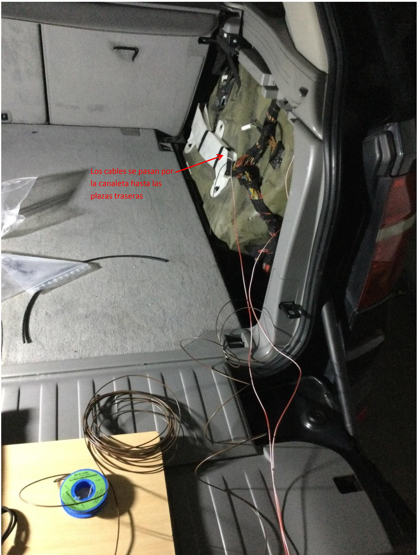
Imagen 20: se pasan los cables de masa (marrón/negro) y alimentación (rojo/blanco) del soporte lumbar del pasajero desde la caja de fusibles al conector del asiento
