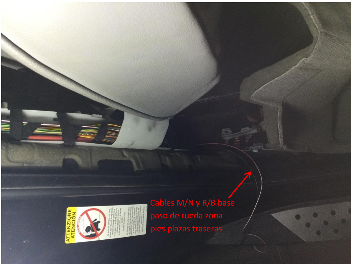
Imagen 22: Cables de masa y alimentación del soporte lumbar del pasajero. Desde orejera de asiento plazas traseras a paso de rueda
