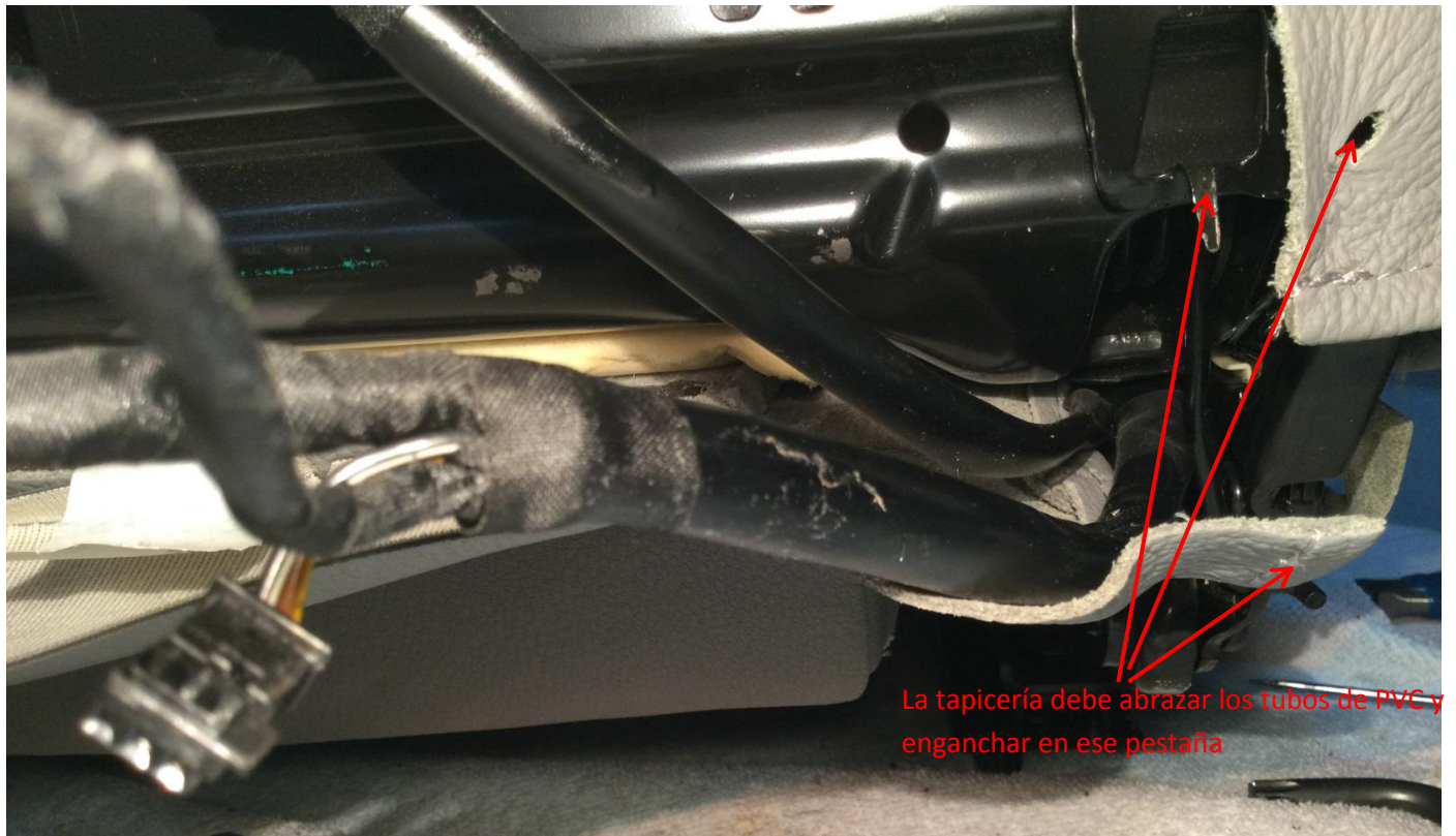
Imagen 112: Ubicación de tubos de PVC automotriz se pasó de cables de base a respaldo de asiento conductor SPORT
