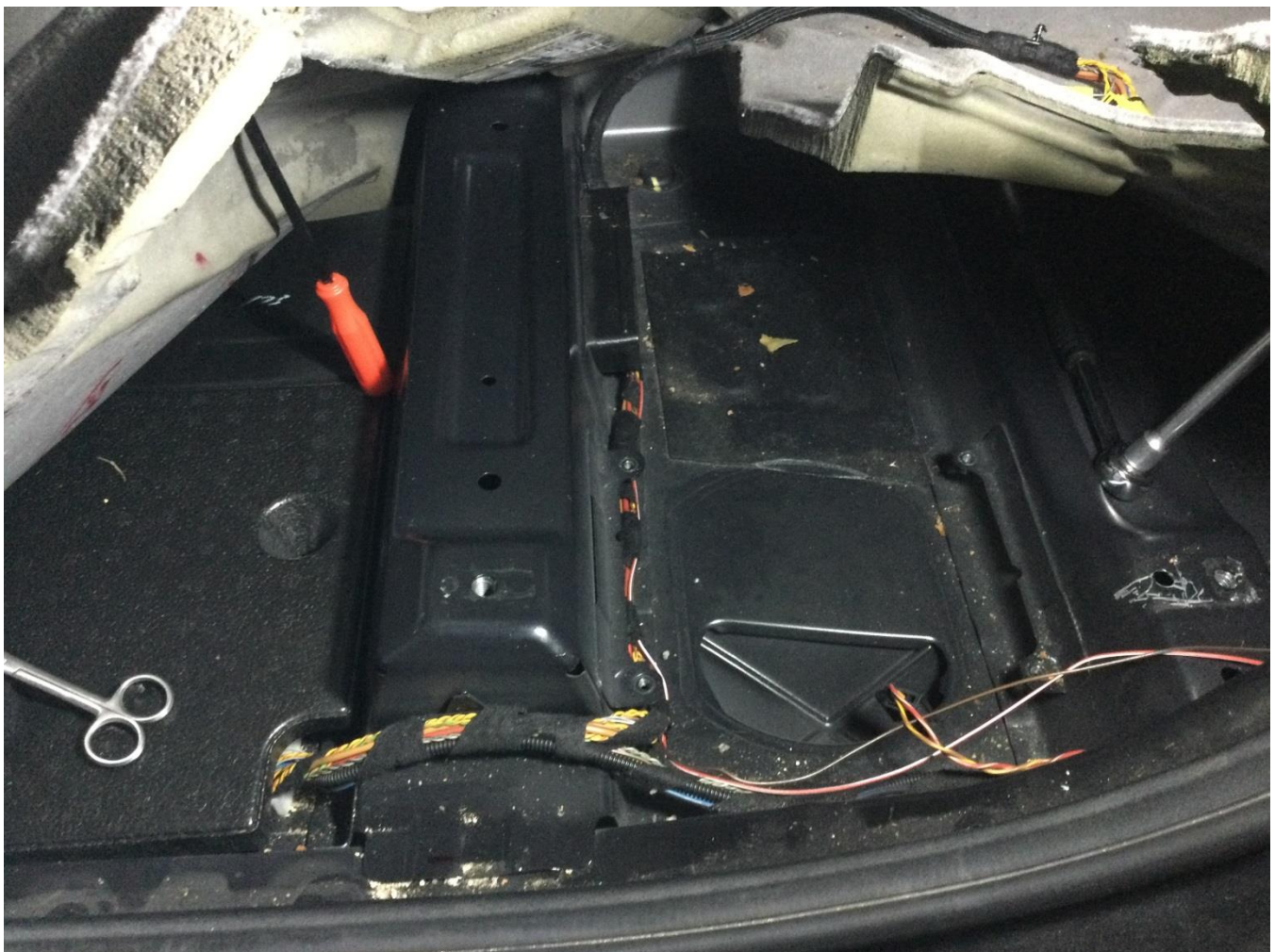
Imagen 90: Moqueta levantada zona conductor. Se ha retirado el altavoz con los 4 tornillos de fijación de este junto con su carcasa de plástico y el conducto del aire acondicionado
