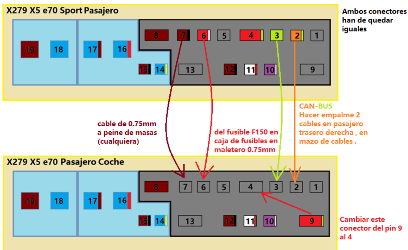
Ilustración 1: Resumen de operaciones a realizar en forma esquemática. Conector X270 Pasajero coche y asiento Sport pasajero
