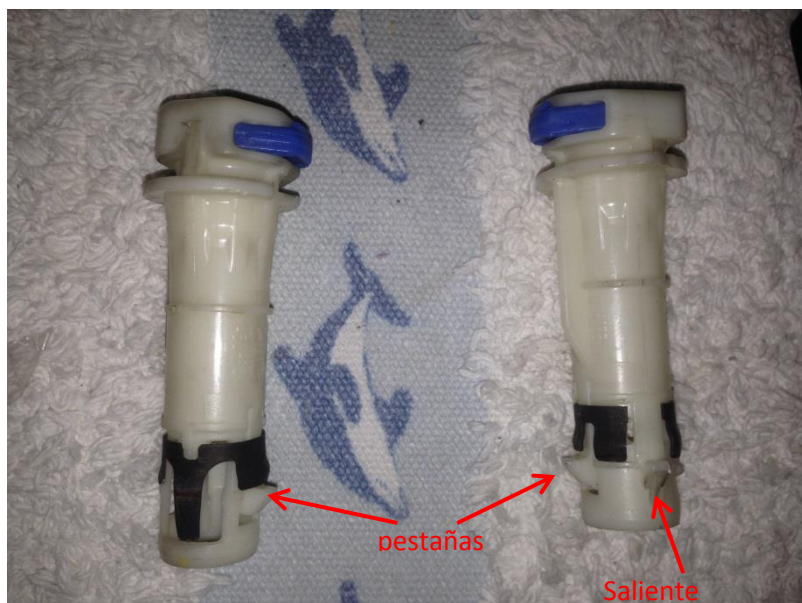
Imagen 82: Guías del reposacabezas activo fuera de su alojamiento
