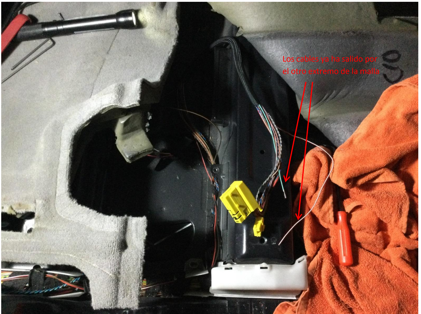
Imagen 25: Cables de masa y alimentación del soporte lumbar del pasajero a conector del asiento
