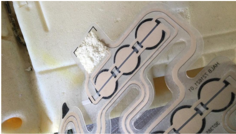
Imagen 60: La cinta de doble cara arrastra parte del relleno cuando se retira
