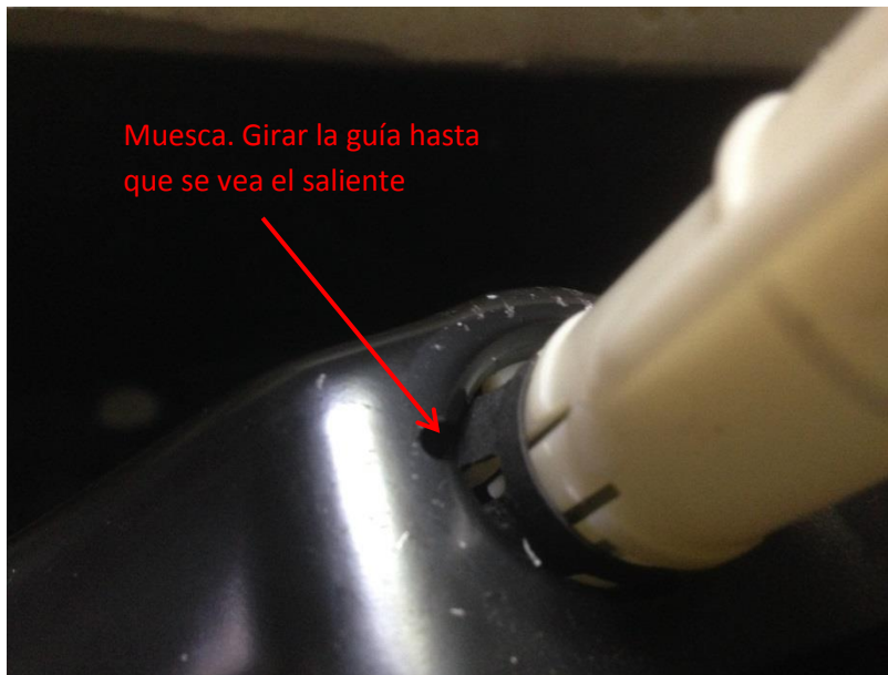
Imagen 80: Proceso de extracción de la guía del reposacabezas activo. Giro hasta encontrar la posición de extracción
