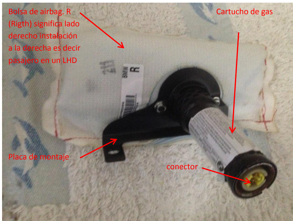
Imagen 49: Airbag lateral asiento compuesto por cartucho de gas o pirotécnico, bolsa de airbag y placa de montaje
