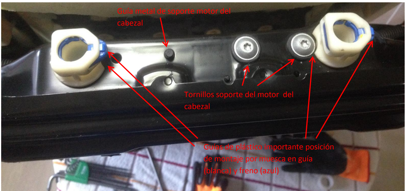
Imagen 77: Posición de instalación de guías del reposacabezas activo
