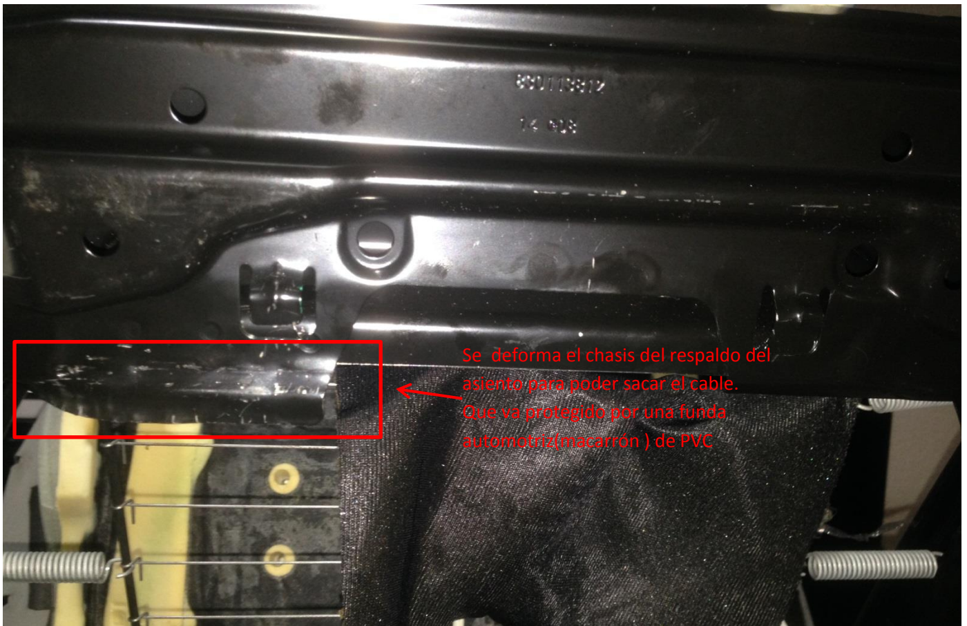
Imagen 76: Chasis del respaldo del asiento. Vista posterior. Deformación de placa de metal para liberar el cable de alimentación del motor del reposacabezas
