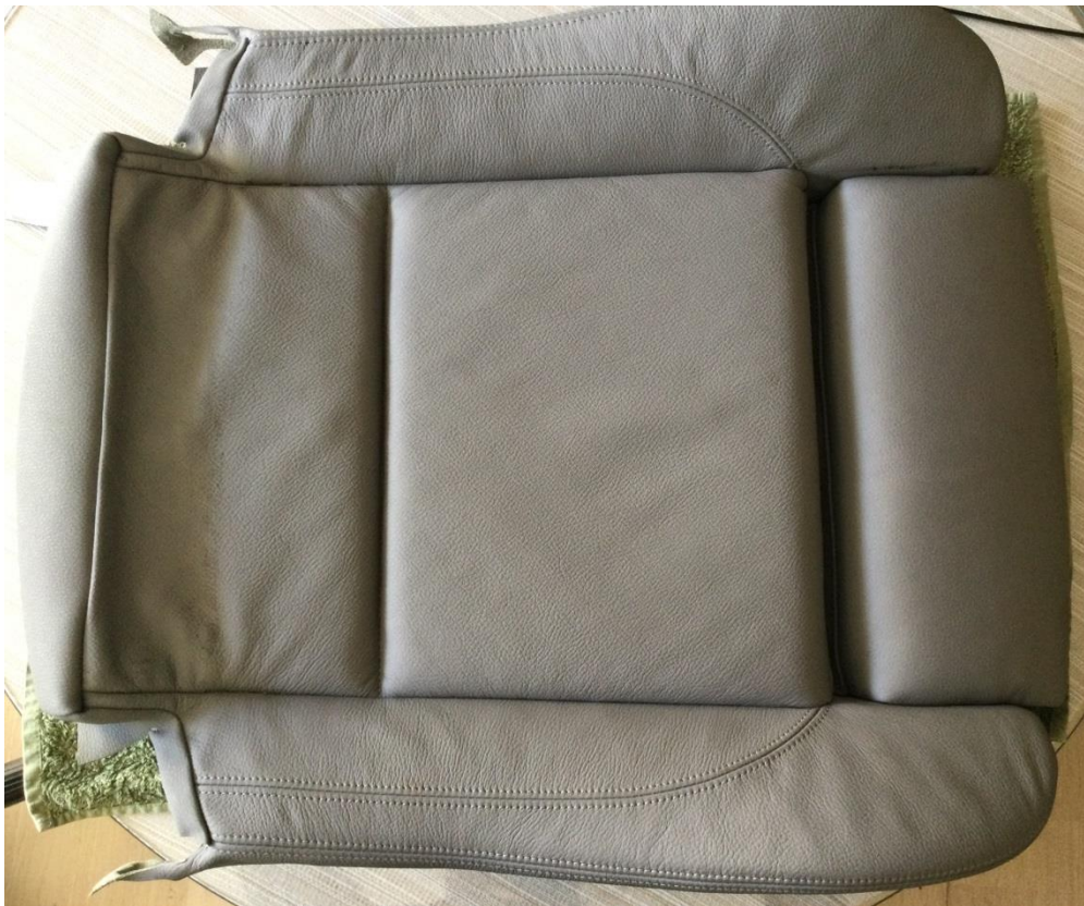
Imagen 64: Tapicería y relleno de la base del asiento SPORT pasajero
