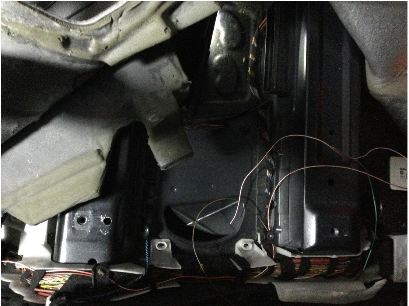
Imagen 23: Cables de masa y alimentación del soporte lumbar del pasajero. Zona de pilar y zona pies asiento pasajero
