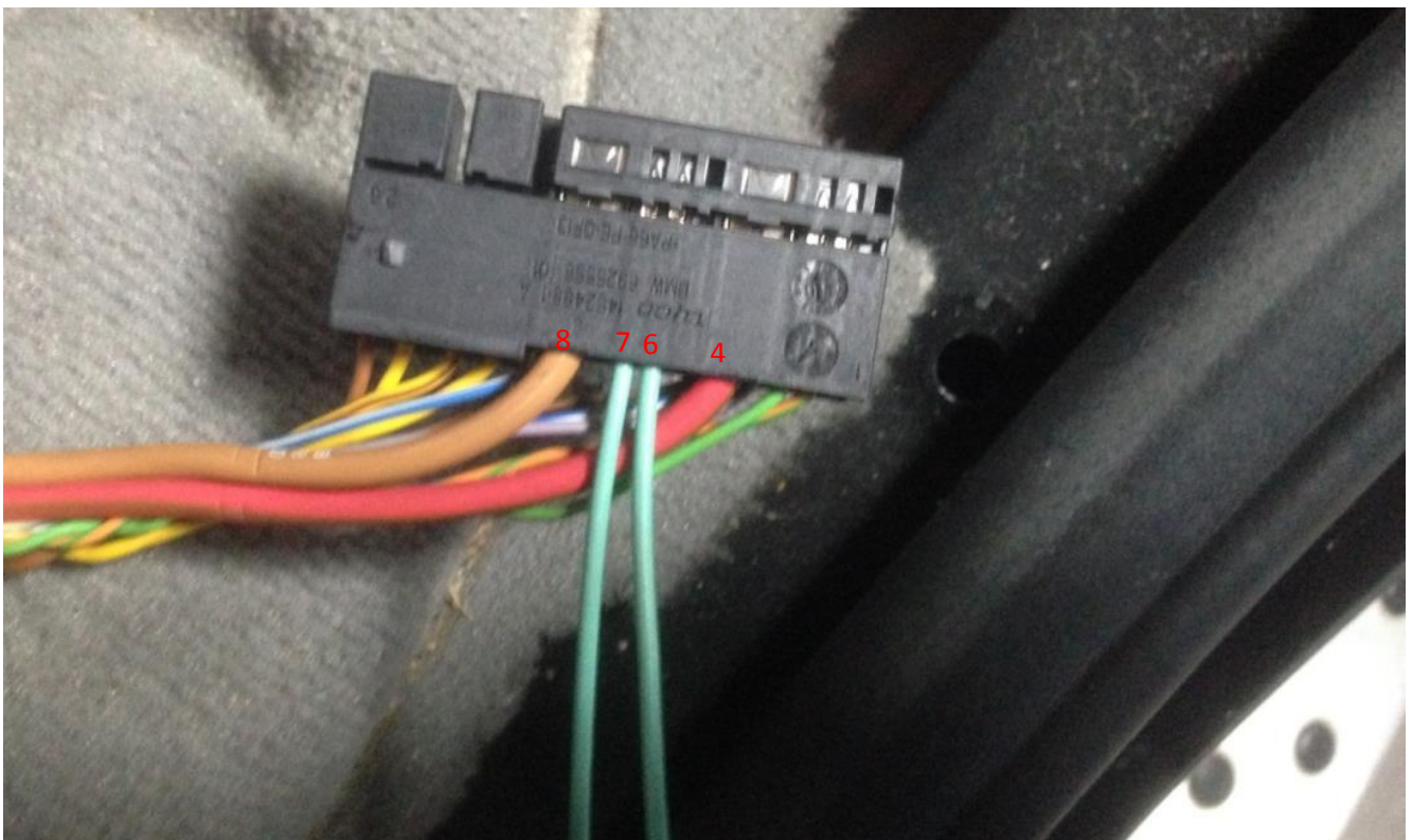
Imagen 93: Contactos de masa y alimentación de soporte lumbar, insertados en los puertos 6 y 7 del conector de coche lado conductor
