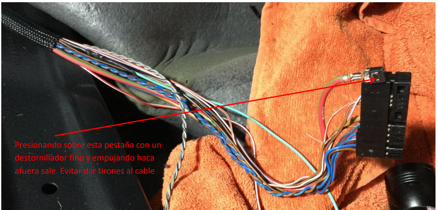
Imagen 32: Conector de cable de alimentación (4mm Rojo/verde) del movimiento del asiento fuera de su bahía (puerto)
