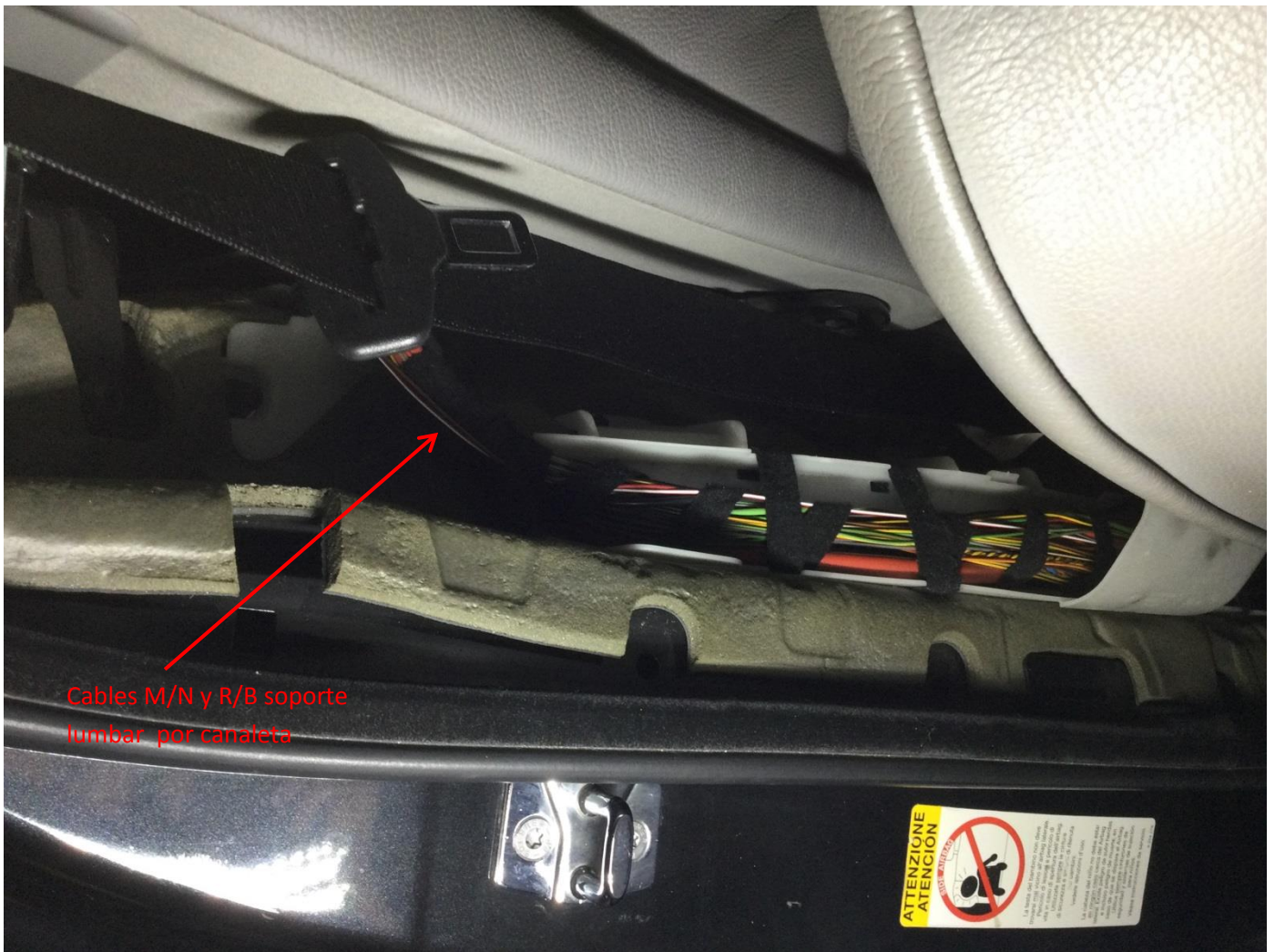
Imagen 21: Cables de masa y alimentación del soporte lumbar del pasajero. Desde caja de fusibles a plazas traseras por orejera de asiento de plazas traseras
