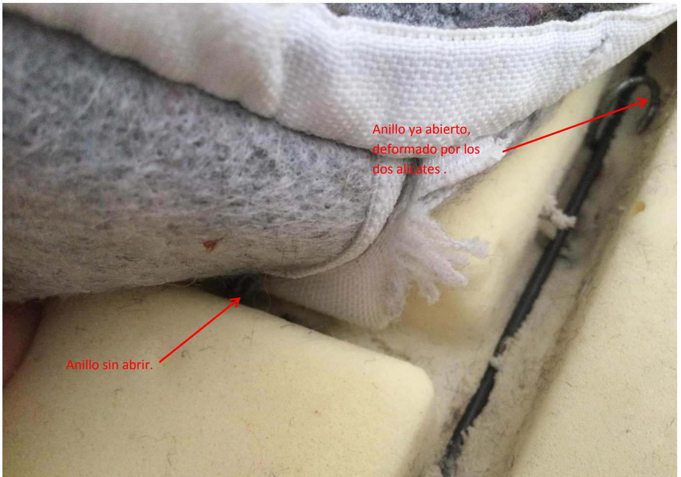
Imagen 56: Ubicación de anillos de cerdo que une los alambres de la tapicería y relleno al chasis
