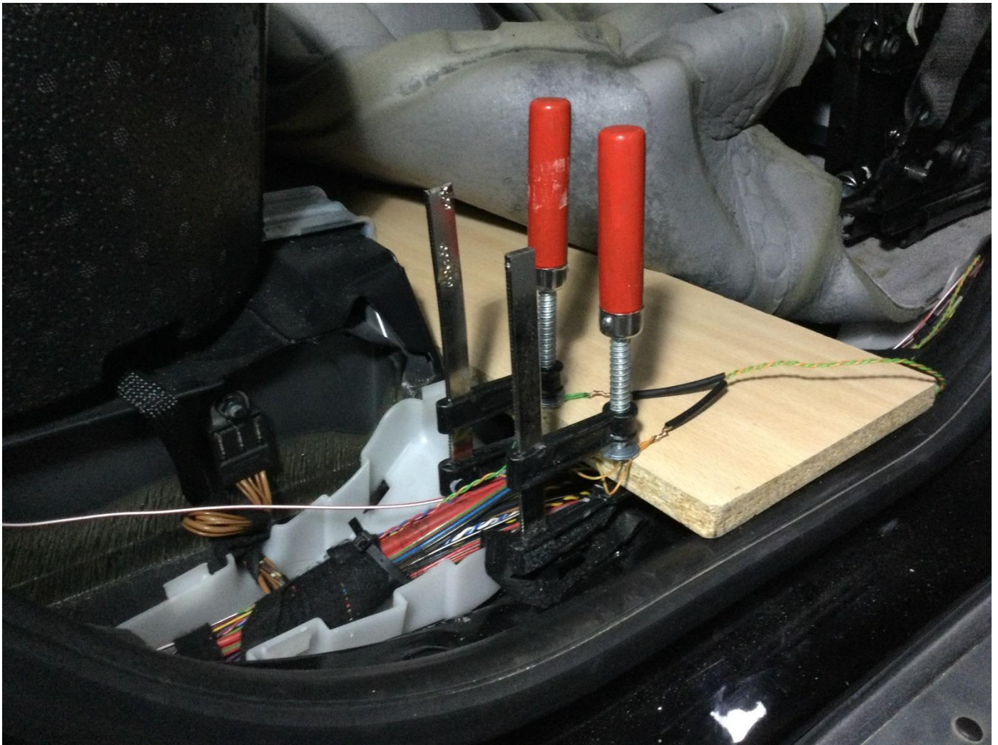
Imagen 44: Soporte de trabajo formado por tabla u sargentos para soldar los cables K-CAN del asiento del pasajero al empalme múltiple
