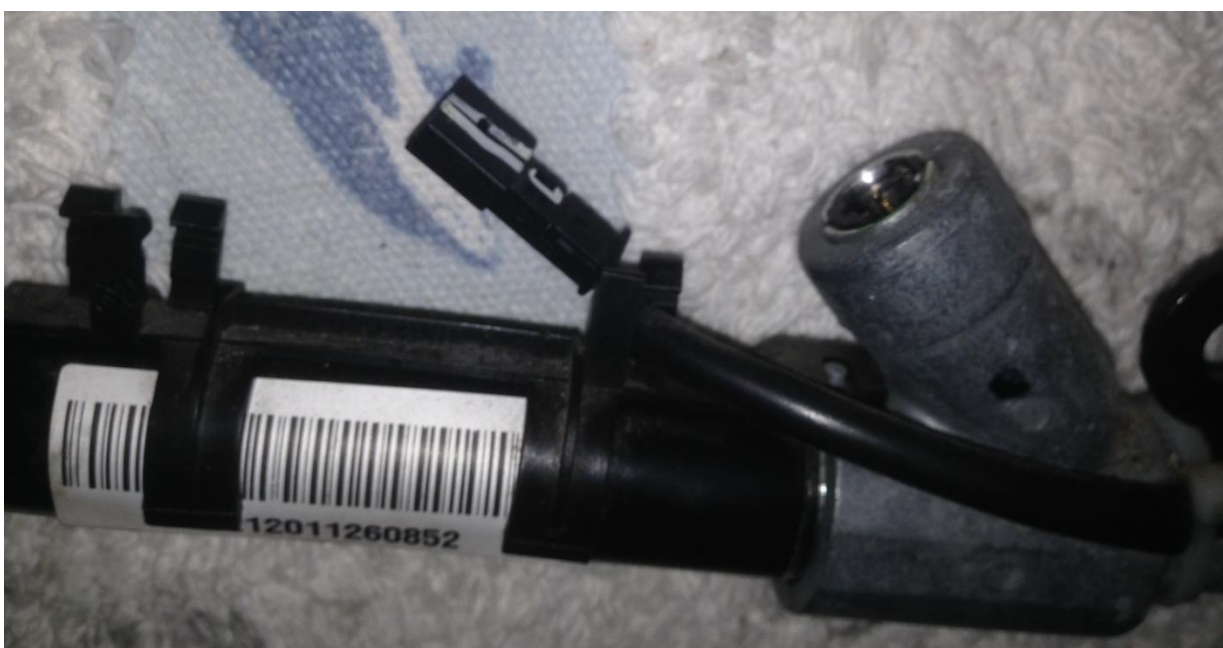
Imagen 52: Detalle de las conexiones del pirotécnico y contacto de hebilla del cinturón
