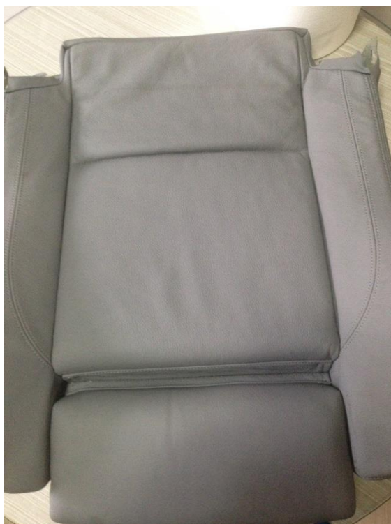
Imagen 73: Tapicería y el relleno (Foam) ya unidas en asiento pasajero SPORT con esterilla instalada
