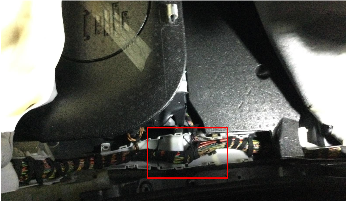
Imagen 42: Ubicación empalmes K-CAN X15011 y X15012 encintados
