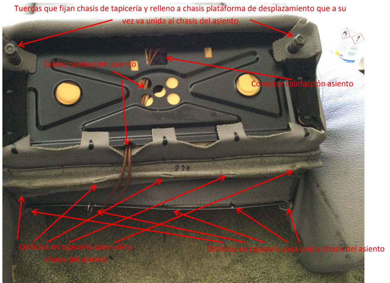
Imagen 65: Bandeja extensible desmontada del chasis del asiento SPORT pasajero
