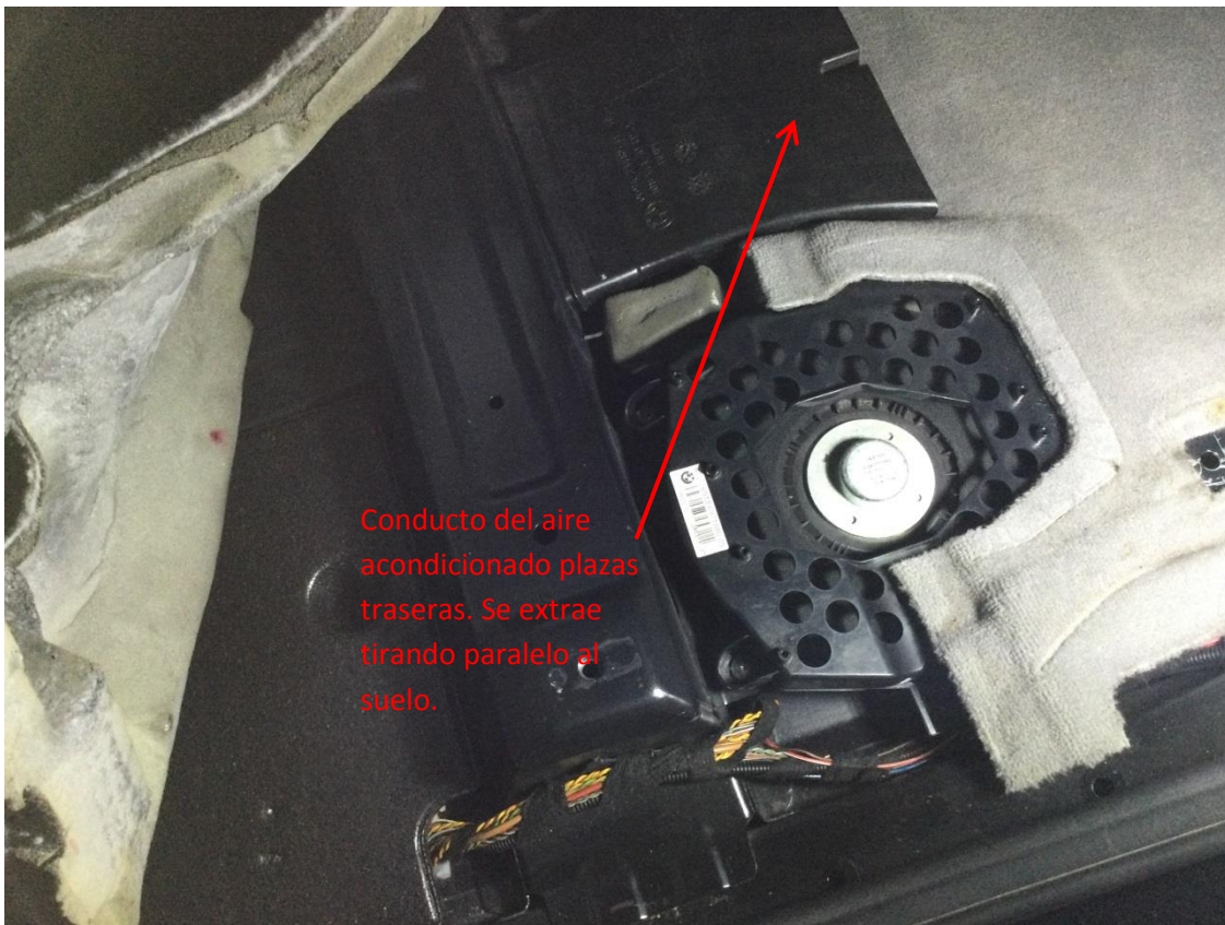
Imagen 89: Tapa altavoz retirada y moqueta parcialmente levantada. Zona conductor
