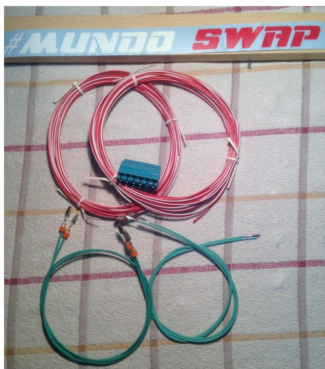
Imagen 4: Materiales conexión alimentación apoyo lumbar SMFA y SMBF
