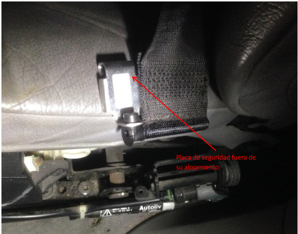
Imagen 85: Liberación de cinturón de seguridad del asiento del conductor Normal de su anclaje
