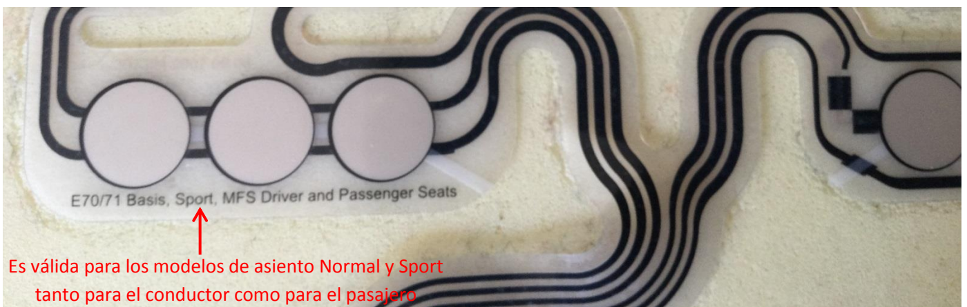
Imagen 58: Detalle de sensor de ocupación (esterilla) verificación de la idoneidad del modelo
