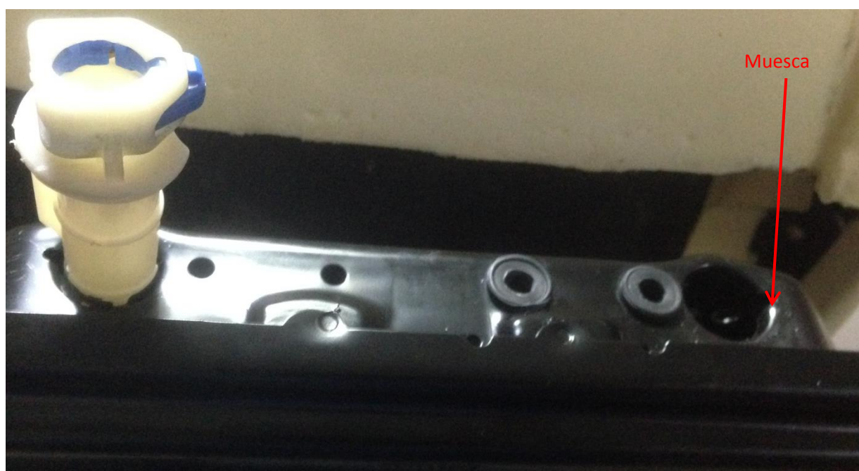
Imagen 79: Guías de plástico parcialmente desmontadas. Ubicación de la muesca de montaje
