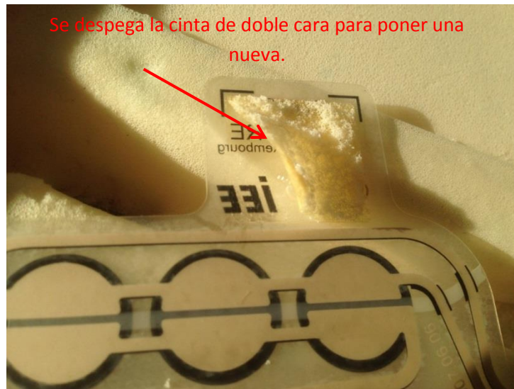
Imagen 61: Detalle de la cinta de doble cara parcialmente despegada en el proceso de su retirada
