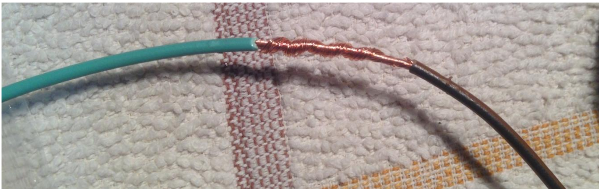
Imagen 29: Empalme cable 0.75 mm 2 de sección y cable de contacto MQS cable 0.75 mm 2 y cable de masa
