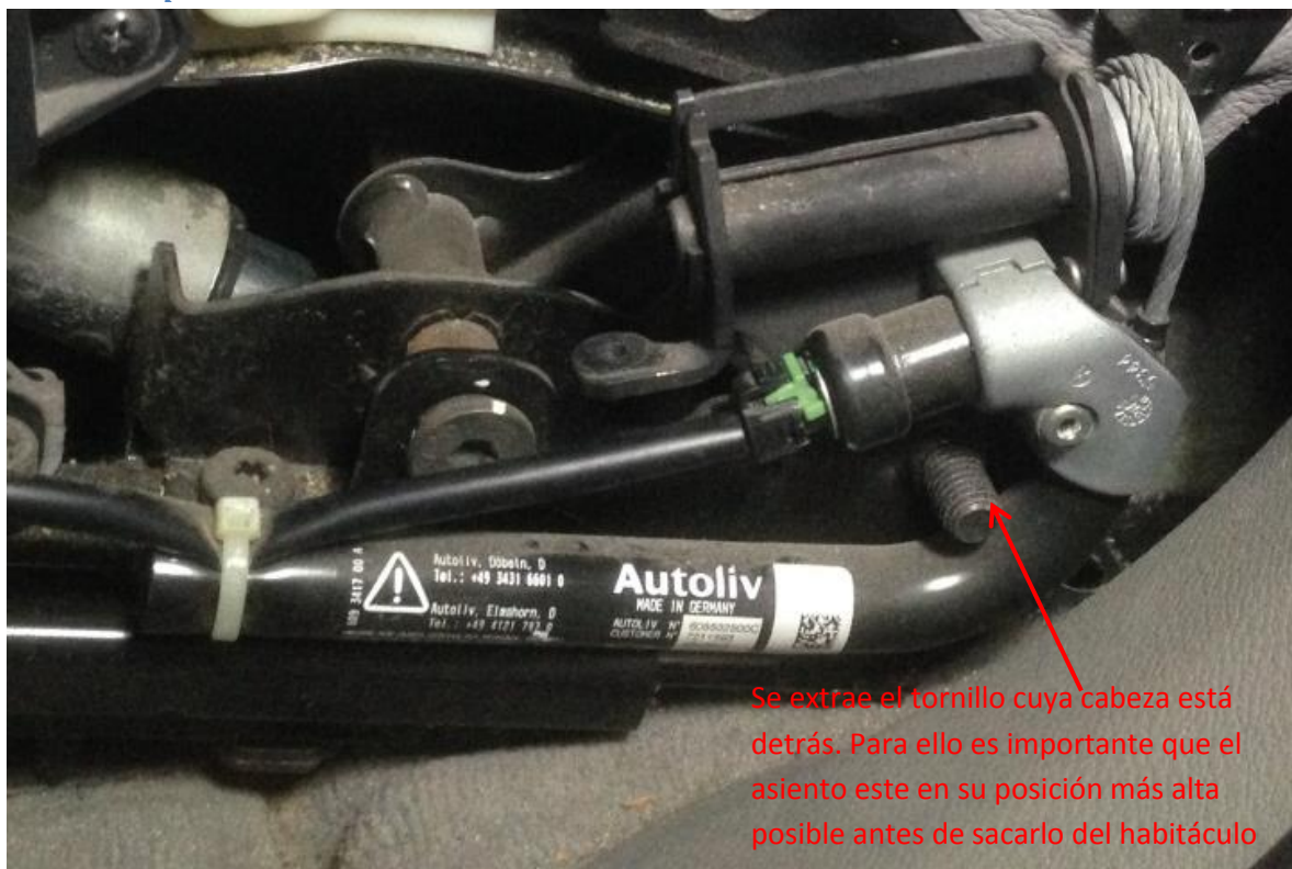
Imagen 104: Pretensor del asiento del conductor instalado en asiento en el interior del coche
