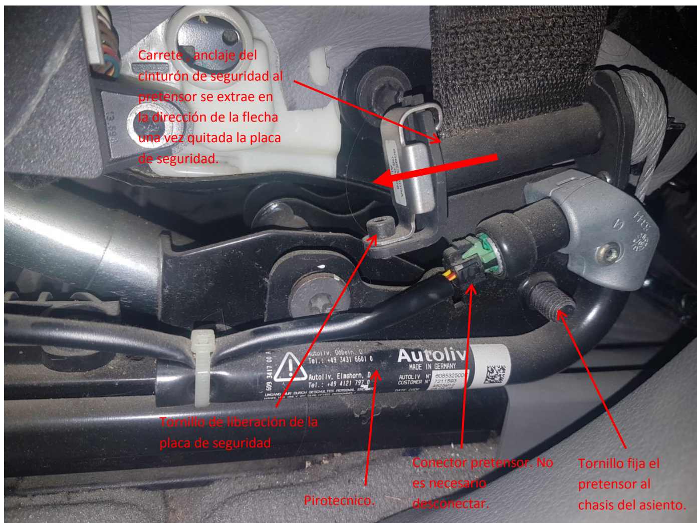
Imagen 84: Pretensor del cinturón. Asiento conductor Normal
