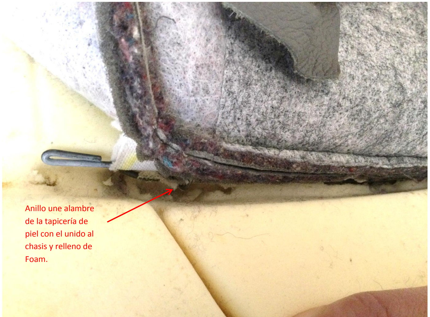
Imagen 55: Ubicación de anillo de cerdo que une los alambres de la tapicería y relleno al chasis
