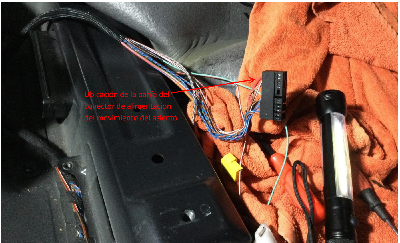
Imagen 31: Ubicación alimentación del movimiento del asiento cable de 4mm de sección
