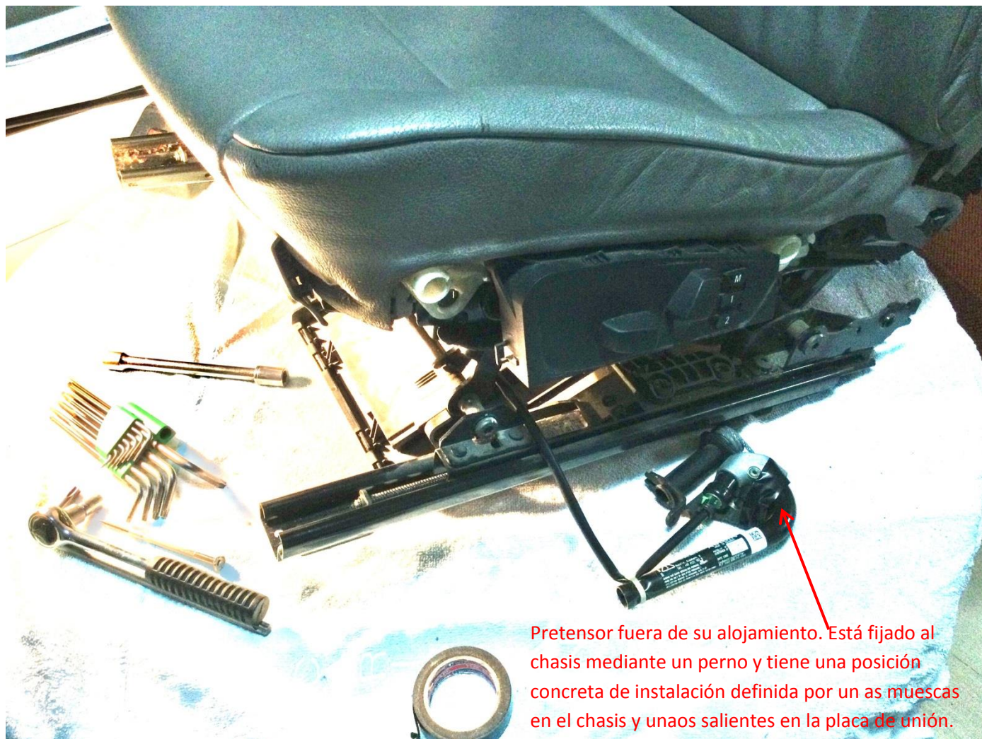
Imagen 106: Pretensor del asiento del conductor normal desinstalado en asiento fuera del coche
