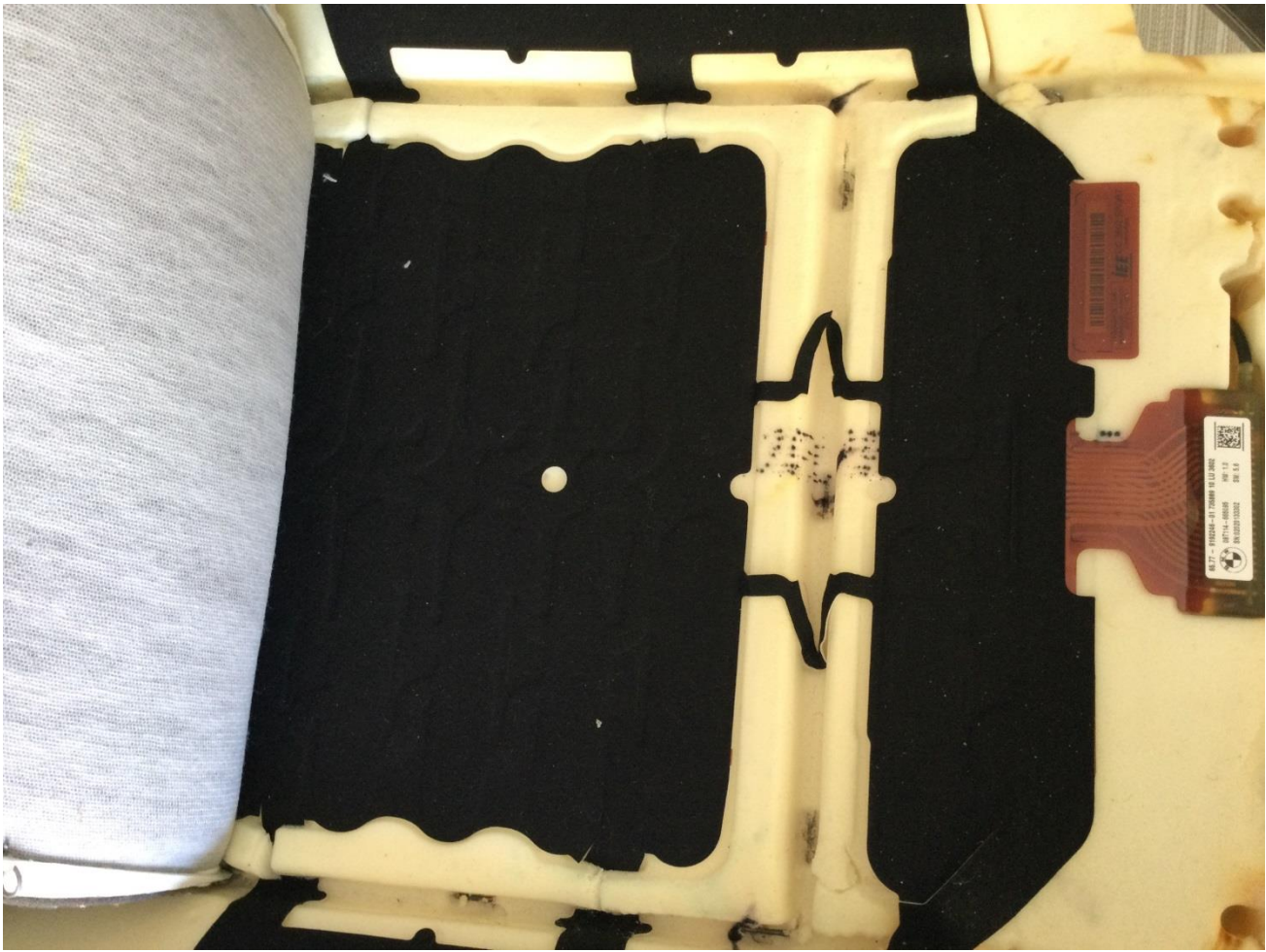
Imagen 68: Sensores de detección de presencia (esterilla) modelo SPORT pasajero
