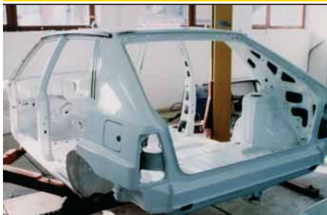
Ovako je sve počelo. Serijska Lancia rastavljena je do temelja, a tvornički dijelovi zamijenjeni su onima ručne izrade. To je bio početak Lancie made in HR
