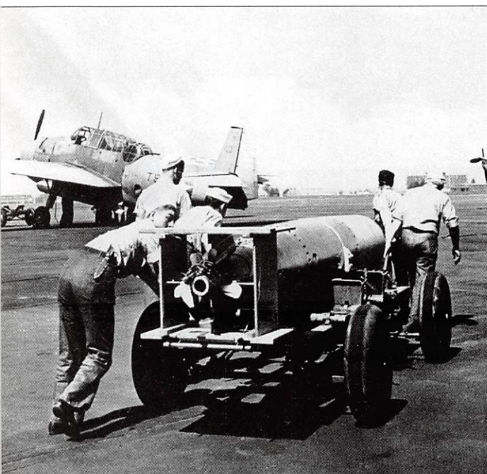
En 1943, une torpille de 590 kg sur son chariot de chargement, l'empennage et l'hélice protégés par des planchettes. Ce n'est pas la torpille carénée de 1944. (Northrop-Grumman Historical Center)
