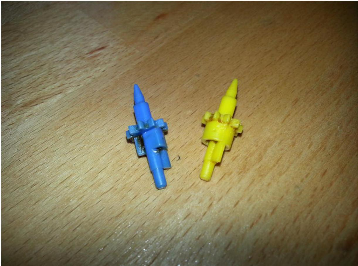
Das blaue mit der Nocke gehört in den rechten Motor, da über den von der Nocke gesteuerten oberen Kontakt m.W. die Pumpe angesteuert wird. Beim gelben Ritzel bleibt der obere Kontakt aufgrund des umlaufenden Durchmessers immer offen. Das gelbe gehört deswegen in den 3-Pin Motor links.
