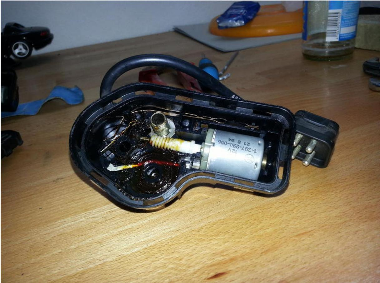
Bei der ersten Demontage befanden sich im linken Motor mit dreipoligem Stecker die beiden gelben Zahnräder...
