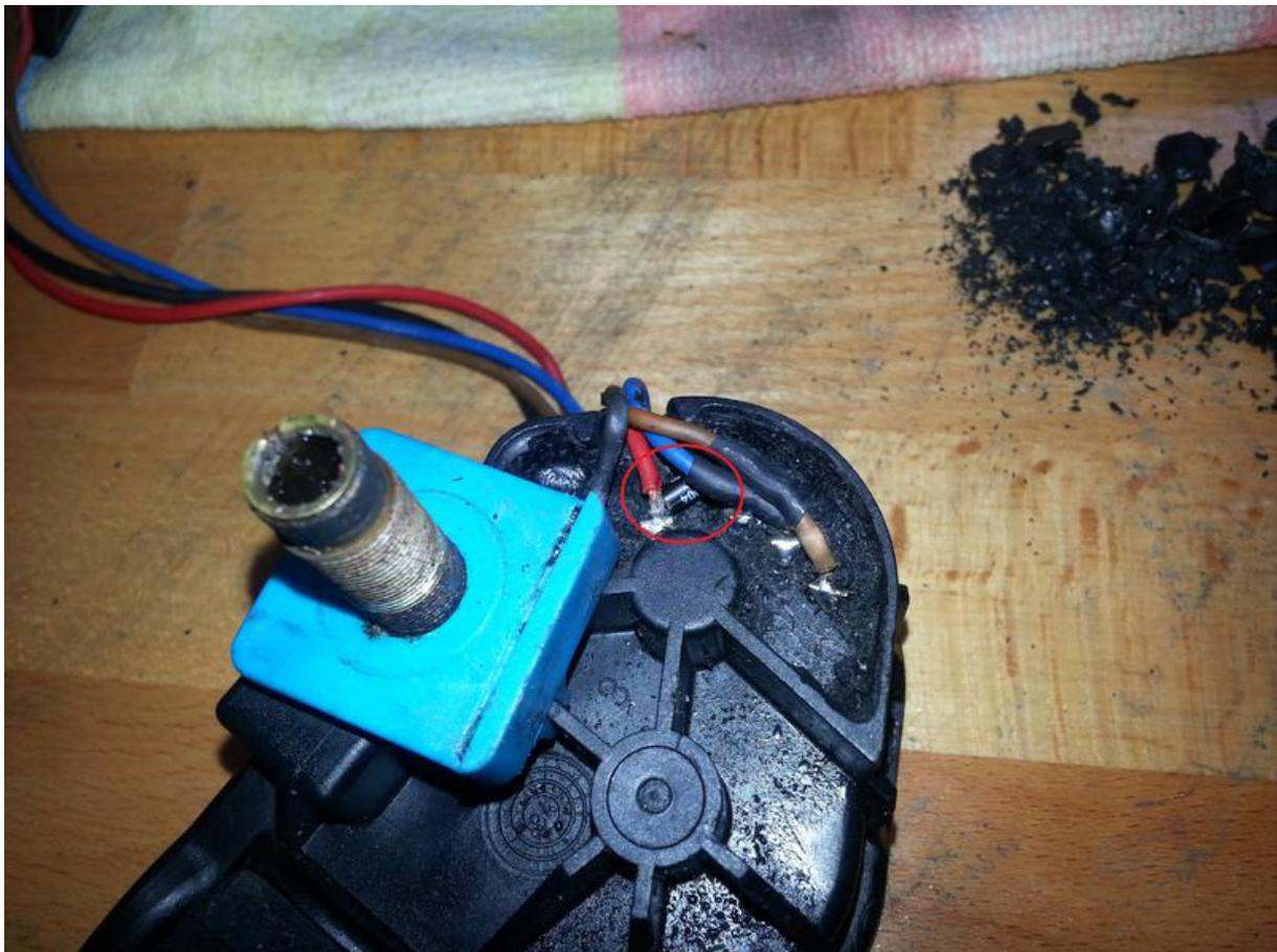
Nachdem in beide Motoren neue Dioden eingelötet wurden machen jetzt beide brav wieder ihre zwei Umdrehungen und die Pumpe pumpt auch mit. Morgen werden die Kontakte wieder mit Silikon versiegelt.
