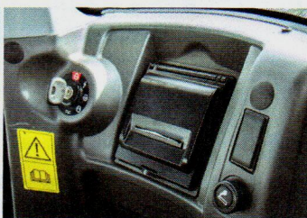
Szalagíró készülék a műszerfalon: írásban bizonylatolhatunk
