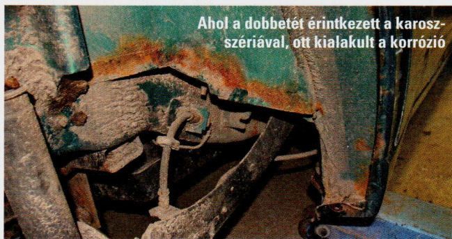
Fontos pontok: felbukkant a rozsdá a kerékjáratok íveken, elöl és hátul
