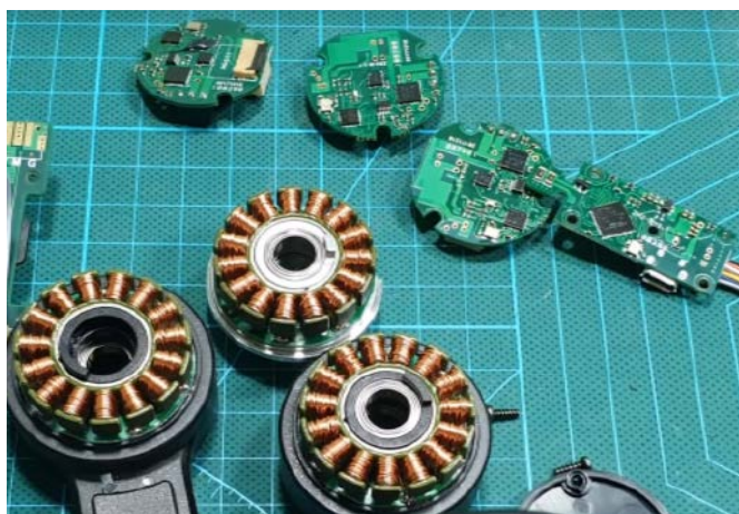
Fotografia 6. Elementy komercyjnego gimbalu przeznaczonego do smartfonów. Widoczne trzy płytki kontrolerów BLDC oraz statory silników, odpowiedzialnych za ruch poszczególnych osi (t.ly/MrRL)
