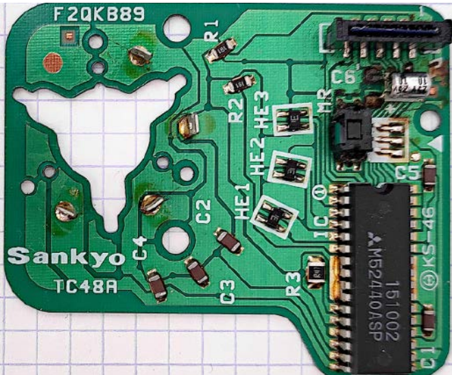
Fotografia 10. Płytkę drukowaną zawierającą sterownik silnika bezszczotkowego oraz pełniącą funkcję podstawy konstrukcyjnej dla całego napędu. Warto zwrócić uwagę na cztery konektory, wlotowe wokół wycięcia po lewej stronie PCB: prawy dolny konektor jest niepodłączony do reszty układu i odgrywa rolę wewnętrznego węzła uzwojeń, wykonanych w topologii gwiazdy (oprac. własne autora)
