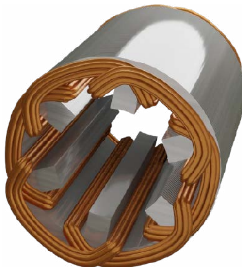
Rysunek 17. Uproszczona budowa statora silnika BLDC z uzwojeniami zachodzącymi na siebie (t.ly/MsRu)
