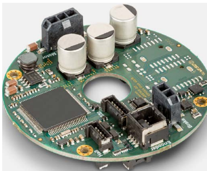
Fotografia 17. 60-milimetrowy sterownik do zabudowy w konstrukcjach serwonapędów – EPOS4 Disk 60/8 CAN marki maxon (t.ly/poAv)
