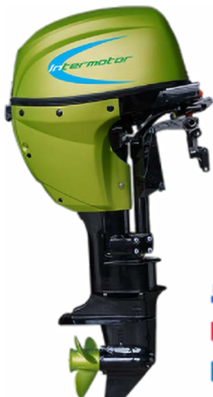
Fotografia 3. Lekki napęd łodzi elektrycznych bazujący na silniku BLDC (t.ly/0Ecc)
