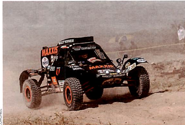
Die Buggys von Tim und Tom Coronel firmieren in der Nennliste als Suzuki Swift GL, sind aber Eigenbauten mit Hayabusa-Motor und Heckantrieb
