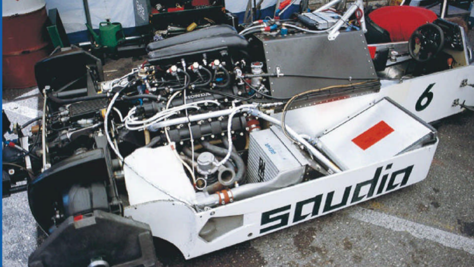
新たにホンダV6ターボを得た84年のFW09。コンパクトとは程遠いエンジンと角ばったボディシエル
