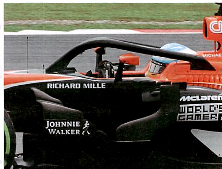
Formel-1-Halo: Dreibeiniges Titangestell, stabiler als der Überrollbügel
