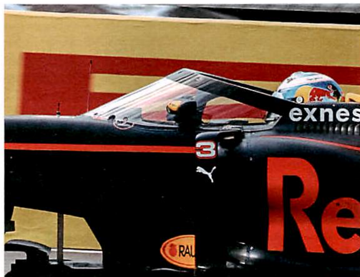
Formel-1-Aeroscreen: Die Scheibe ist vorne wie bei IndyCar gerade
