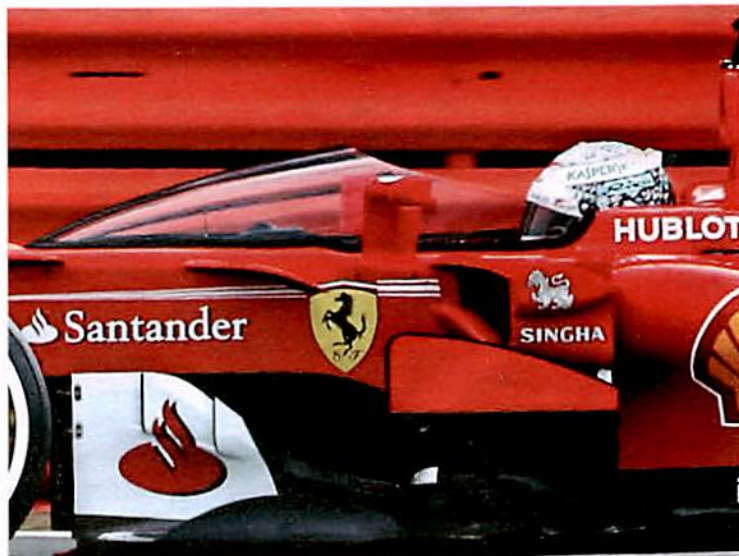
Formel-1-Shield: Die starke Krümmung der Scheibe stört die Sicht
