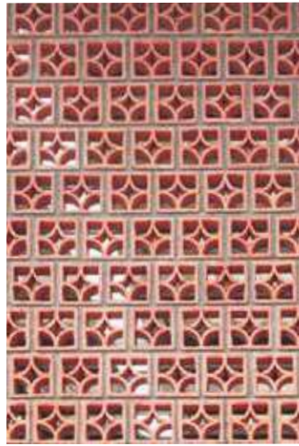
CALADO CIRCULO ROJO DE 10 Tamaño 20x20x10 cms Rendimiento 23 und/ m 2 Peso 3.5 kg/ und
