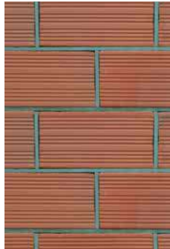
FAROL 3 HUECOS DE 10X40 Tamaño 19x40x10 cms Rendimiento 12 und / m 2 Peso 5.6 kg/und
