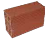
FAROL DE 12X30 Tamaño 19x30x12 cms Rendimiento 16 und / m 2 Peso 5.3 kg/und
