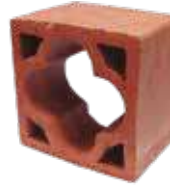
CALADO TREBOL ROJO DE 15 Tamaño 20x20x15 cms Rendimiento 23 und/ m 2 Peso 5.2 kg/ und
