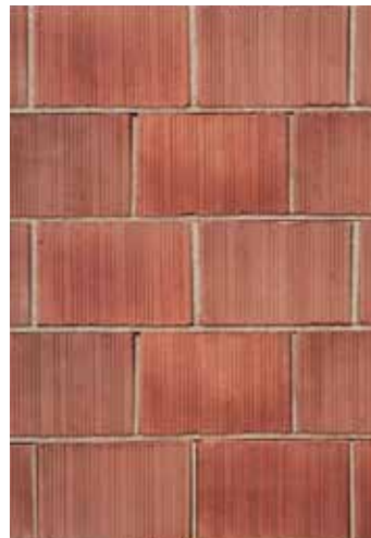
TERMINAL RAYADO DE 10 Tamaño 19x30x10 cms Rendimiento 16 und / m 2 Peso 5.8 kg/und
