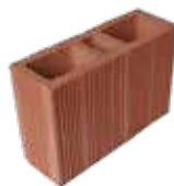
TERMINAL RAYADO DE 10 Tamaño 19x30x10 cms Rendimiento 16 und / m 2 Peso 5.8 kg/und
