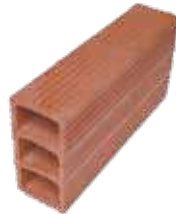
FAROL 3 HUECOS DE 10X40 Tamaño 19x40x10 cms Rendimiento 12 und / m 2 Peso 5.6 kg/und
