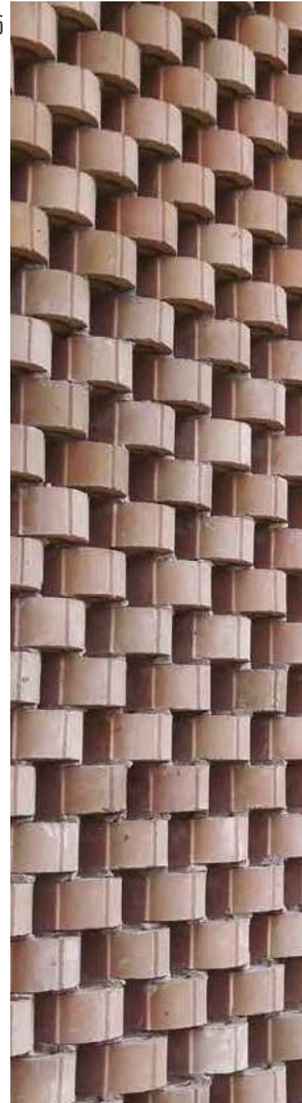
CALADO CIRCULO ROJO DE 15 Tamaño 20x20x15 cms Rendimiento 23 und/ m 2 Peso 5.2 kg/ und
