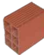
FAROL 6 HUECOS MEDIO DE 12 Tamaño 19x20x12 cms Rendimiento 24 und / m 2 Peso 3.2 kg/und
