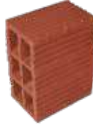
FAROL MEDIO DE 10 Tamaño 19x15x10 cms Rendimiento 30 und / m 2 Peso 2.5 kg/und
