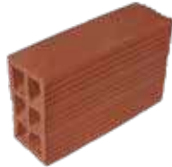
FAROL DE 10X30 Tamaño 19x30x10 cms Rendimiento 16 und / m 2 Peso 4.8 kg/und
