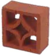
CALADO CIRCULO ROJO DE 10 Tamaño 20x20x10 cms Rendimiento 23 und/ m 2 Peso 3.5 kg/ und
