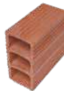
FAROL 3 HUECOS MEDIO DE 10 Tamaño 19x20x10 cms Rendimiento 23 und / m 2 Peso 2.9 kg/und
