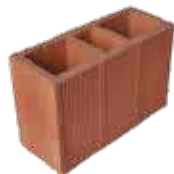
TERMINAL RAYADO DE 12 Tamaño 19x30x12 cms Rendimiento 16 und / m 2 Peso 6.4 kg/und
