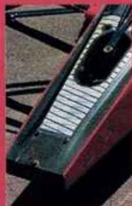
〔左上〕コクピット前部には独特の突起とプレートが追加された〔上〕メタルストリップがつけられたフロントボックス
