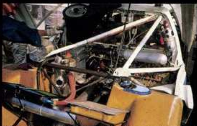
リヤカウルを撥ね上げてサービスを受ける、プジョー205。ミッドに横置きで搭載されるエンジンはロールケージの間に沈みこんでいる
