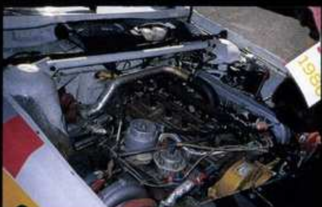
アウディ・スポーツ・クアトロS1のエンジン・ルーム。エンジンは5気筒DOHC20バルブ。ラジエターはリヤウィング部に移されている
