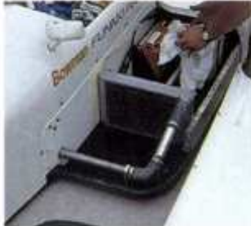
左右のサイドポンツーン内には本当にコンパクトなラジエターが設置される
