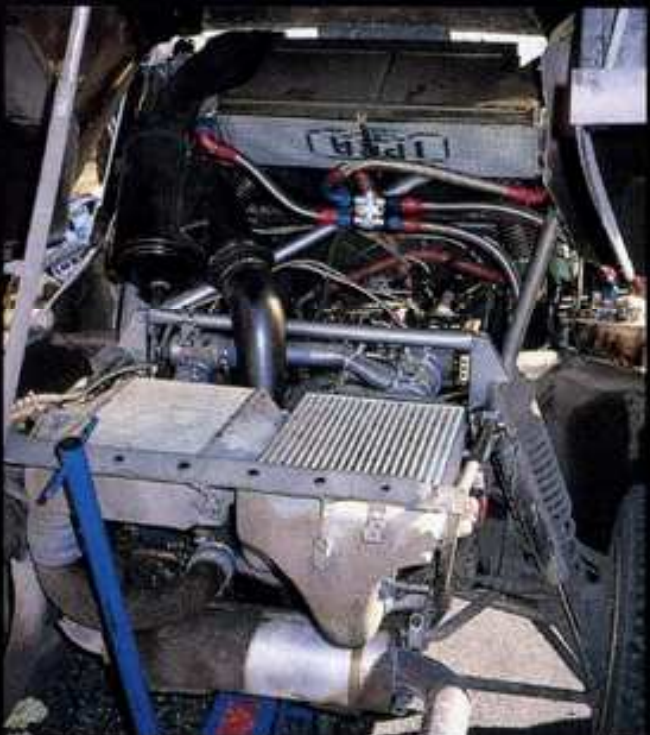
ランチア・デルタS4のエンジン・ルームを後方から見る。ミッドに縦置きされるDOHCエンジンは各種補器類の中に埋もれている
