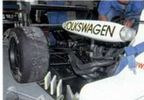
エンジンの右側を通るエキゾーストパイプは専用シャシーらしく複雑な取り回しになっている
