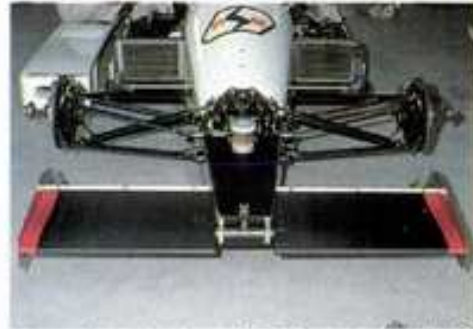
フロントサスペンションはプッシュロッド方式を採用。ショックはモノコック内部にマウントされる
