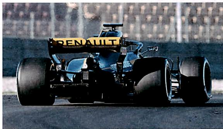
Der angeblasene Heckflügel sorgt für Extra-Grip am Kurvenausgang
