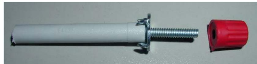
Kleber ausgehärtet ist, kannst du das Variometer mal probeweise zusammensetzen: Die Bohrung des Rohres ist etwas kleiner als der Außendurchmesser der Schlagmutter. Mit leichtem Druck lässt sich die Mutter gut in das Rohr schieben. (siehe nächstes Bild)
