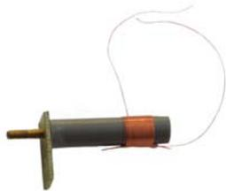
Die Schlagschraube wird mit der Planseite auf ein Stück Leiterkarte gelötet. Dazu eignet sich gut der Streifen, der sich bei Auslieferung noch an der Platine befindet (muss in jedem Fall an der Fräskante abgebrochen werden). Natürlich muss man vor dem Löten erst mal ein 6mm Loch in den
