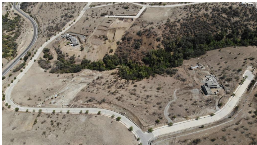
Imagen 9. Procesos de remoción en masa que demuestra la inestabilidad de taludes en un sustrato que sustenta vegetación, área del proyecto Mirador Andino. Fuente: SAG 25 .
