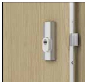
broască în 4 puncte, clasa 4 ENV, pregătită pentru cilindru
