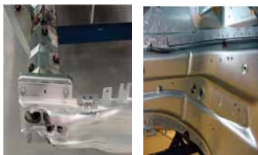
Зоны запрограммированной деформации (складки и отверстия) в модернизированных лонжеронах Volvo.
