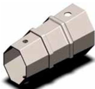
Крашбокс или энергопоглощающий элемент со ступенчатым изменением сечения, используемый в конструкции кузова Volvo S40.
