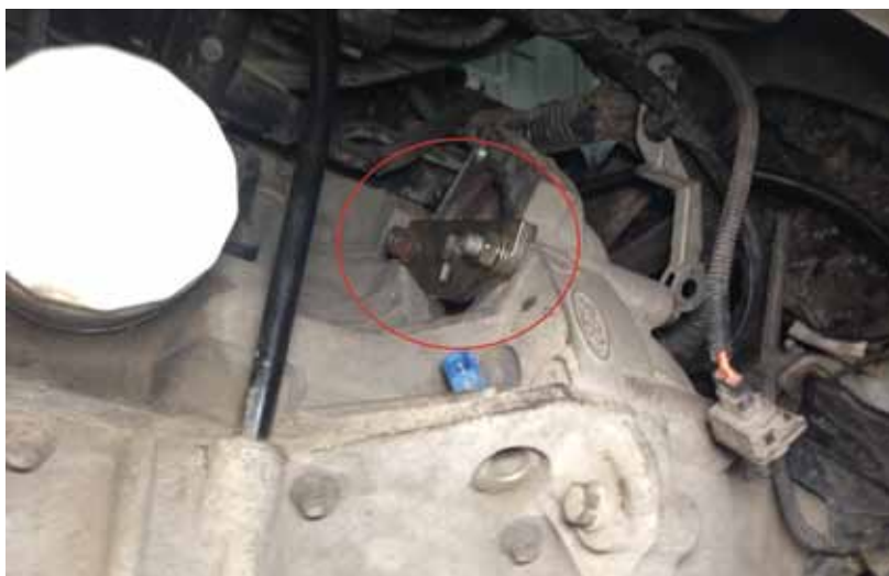
Фиксатор маховика, установленный на место стартера (выделен красным). Для крепления используются два штатных болта крепления стартера и две подходящие гайки
