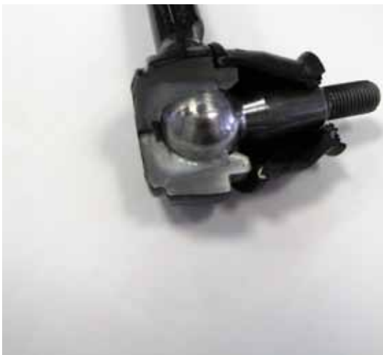
Шарнир в разрезе. Видно крепеж пыльника
