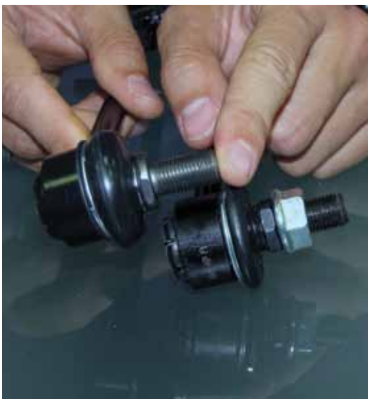
Разница в металле. Справа-подделка
