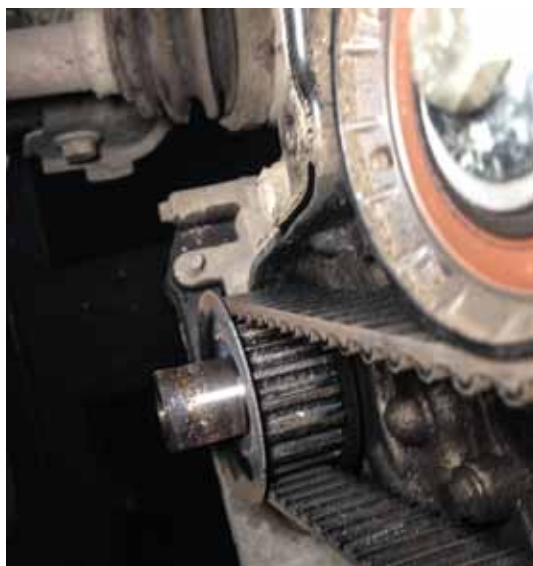
Шестерня ГРМ на коленчатом вале. Видно, что шпонка отсутствует. Также на краю вала виден ржавый уча-
