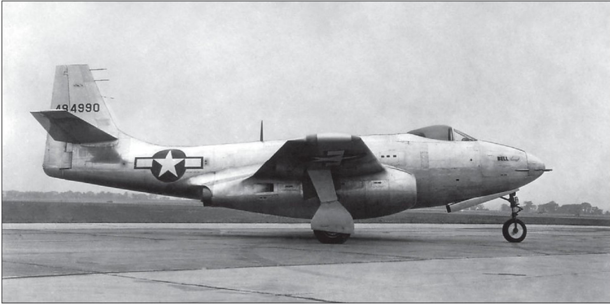
◀ Le Bell XP-83. Ne dépassant pas 840 km/h à 4 800 m, il sera considéré comme un peu « juste » par rapport au Lockheed P-80 et le projet sera abandonné.
