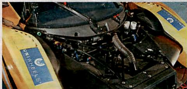
LMP-Niveau: Viel Karbon und filigrane Technik im Vorderwagen
