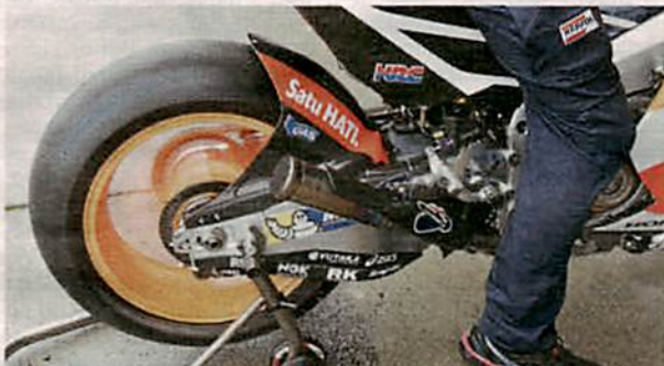
Schwinge strebt gegen den Boden: Kurbelwelle dreht rückwärts
