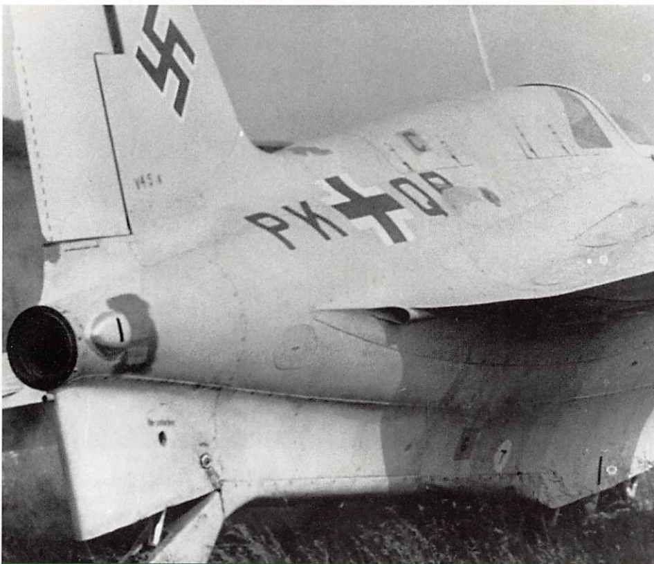
Le Me 163B V45 avec une modification de la ventilation de la tuyère. A l'origine, il y avait deux groupes de fentes sans carénage : trois devant, deux en arrière. Le tube, sous le bord de fuite de l'aile, est très probablement l'orifice d'éjection des étuis d'obus de 30 mm. Ce tube fut remplacé par un système classique, sous l'aile. (Transit Films)
