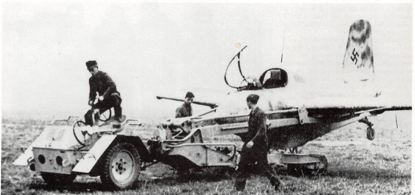
L'attelage très compliqué, utilisé pour soulever et déplacer les Me 163 après leur atterrissage sur leur patin.
