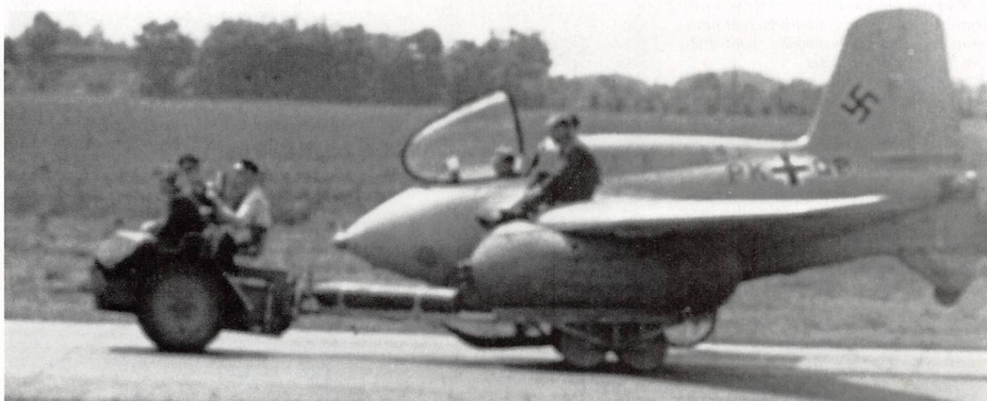
Un système adopté au début, pour ramener les Me 163 vers leur parc : un chariot avec deux bras et des coussins gonflables. La bouteille d'air comprimé est fixée sur la flèche du chariot. (Transit Films)
