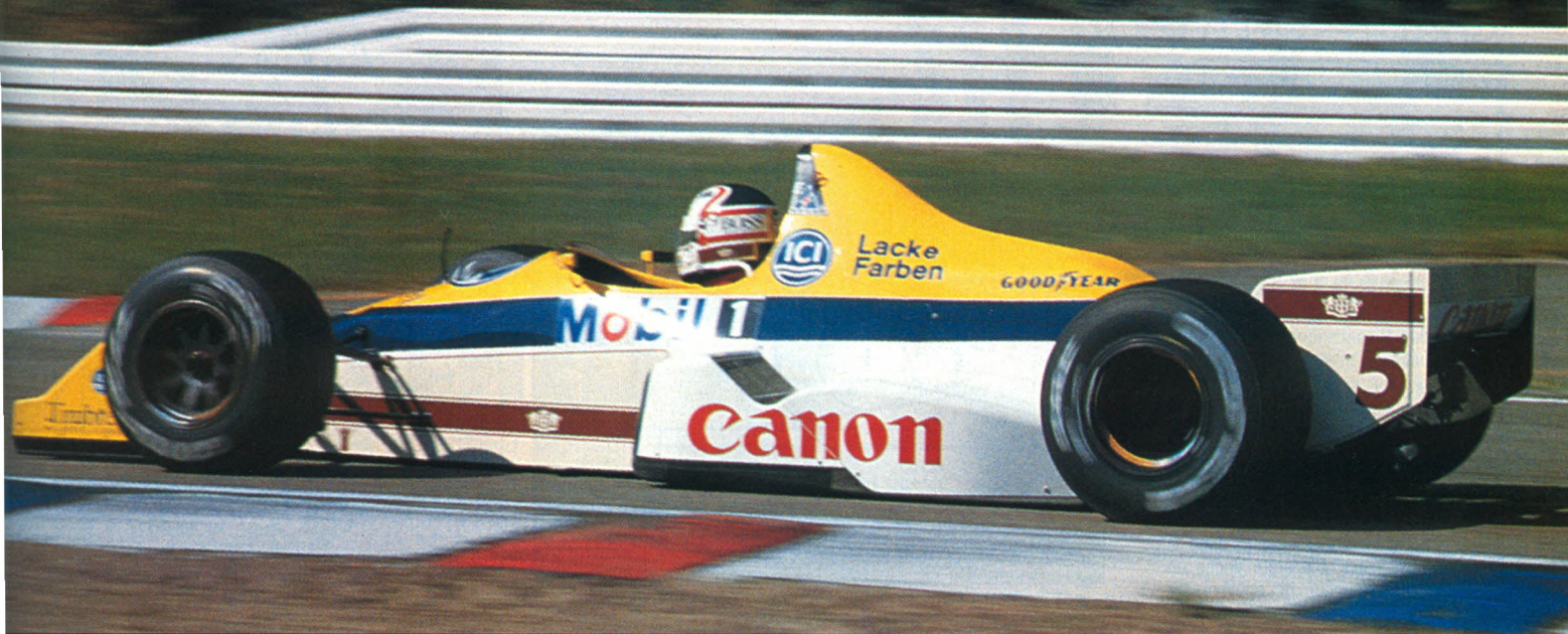
Nigel Mansell con la Williams Fw12 sulla quale è stato montato un alettone posteriore capace di estrarre l'aria dalla parte inferiore, nella zona posteriore, della vettura. In gara ne è stato invece utilizzato uno realizzato in due pezzi FotoColombo)
