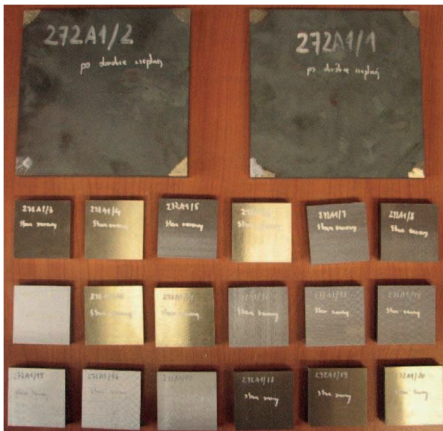
Rys. 5. Próbki do testów przestrzeleniowych przygotowane z blachy NANOS-BA (wytop S272) o wymiarach 150 \text{ mm} \times 150 \text{ mm} \times 12 \text{ mm} i 50 \text{ mm} \times 50 \text{ mm} \times 10 \text{ mm}
