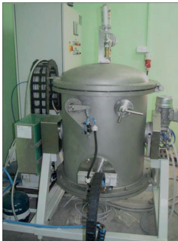
Rys. 12. Stanowisko A3-LPS: zbiornik mieszczący układy do odlewania ciśnieniowego
