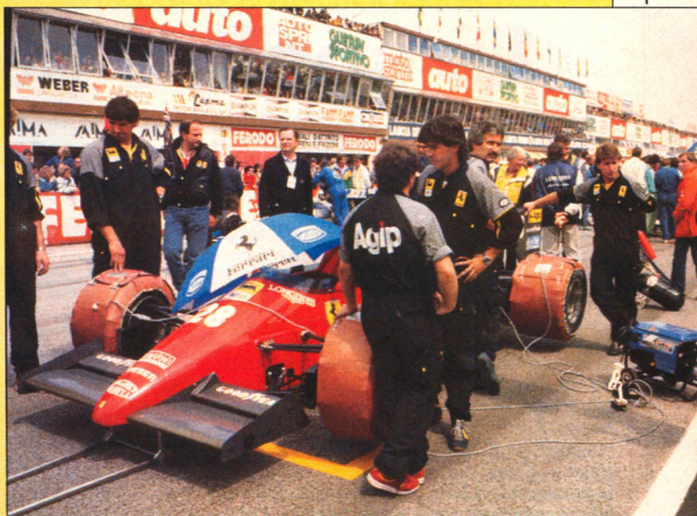
Il sistema Ferrari per mandare in temperatura le gomme si differenzia da quello usato dalle altre squadre (Giovannelli)
