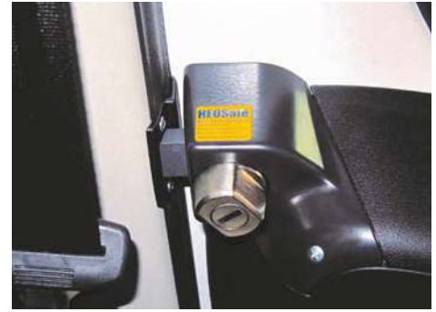
HEOSafe Türsicherung für Fahrerhaustüren Fiat Ducato 250/290 (integriert in die Armlehne)
