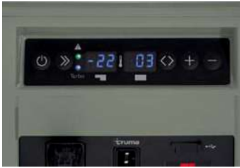
Digital-Display mit Soll-/ Ist-Temperaturanzeige und Bedienteil mit Turbofunktion
