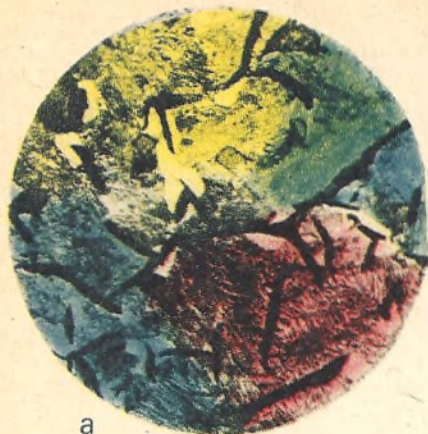
C Porównanie struktury żeliwa szarego i żeliwa sferoidalnego w powiększeniu 500-krotnym: a — żeliwo szare, w którym grafit występuje w postaci płatków rozcinających osnowę metaliczną, b — żeliwo sferoidalne perlityczne, c — żeliwo sferoidalne ferrytyczne
