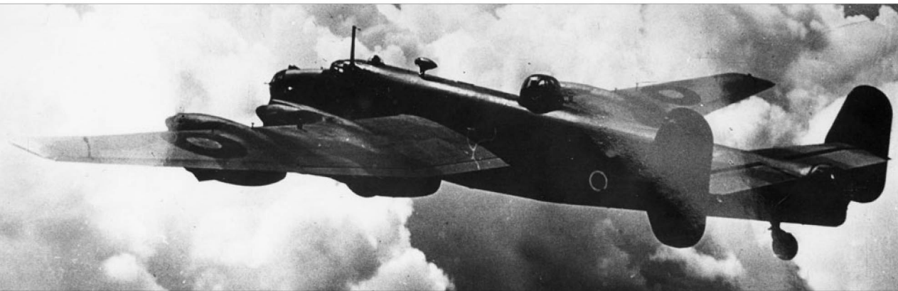
Deux images de "Halifax" B II avec le premier type de tourelle dorsale à deux mitrailleuses légères. L'avion codé ZA appartient au Squadron 295.
