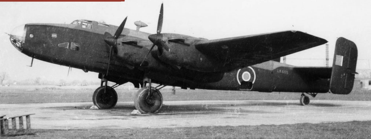
Un "Halifax" Mk V destiné au transport à cause de la fragilité de ses atterrisseurs Dowty. L'avion possède un crochet de remorquage et est armé au moins d'une tourelle de queue.
