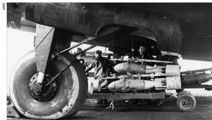
Au premier plan, chargement de bombes dans la soute de l'aile gauche.
