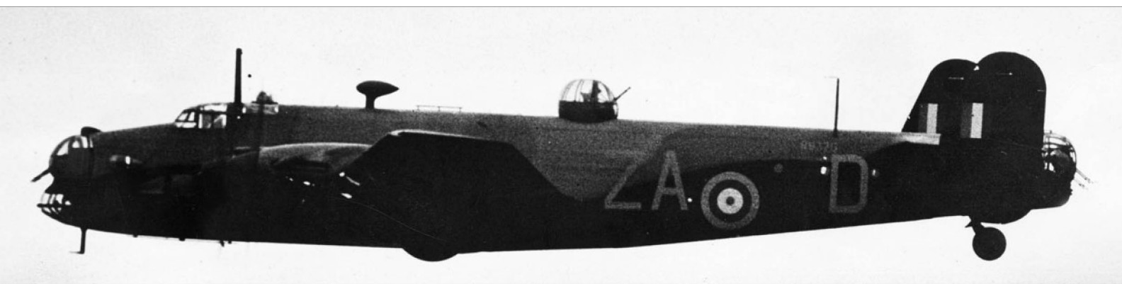
Deux images de "Halifax" B II avec le premier type de tourelle dorsale à deux mitrailleuses légères. L'avion codé ZA appartient au Squadron 295.
