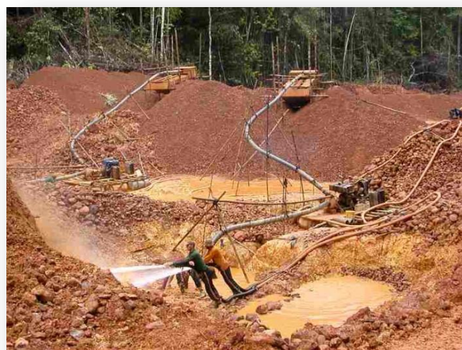
نمایی از روش استخراج پلاسری در یک معدن
