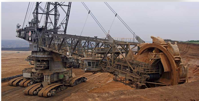
نمایی از ماشین حفاری غول پیکر برداشت زغال سنگ از معدن زغال سنگ قهوه ای در آلمان
