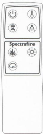
Когда происходит переключение функции с панели управления или пульта дистанционного управления загорится соответствующий световой индикатор. Индикатор сигнализирует о переключении функции и выбранном Вами уровне мощности. Когда функция выключается, соответствующий индикатор мигнет несколько раз, потом погаснет.
