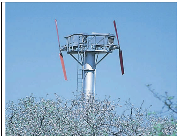
• نگاره‌ی ۱۹-۳ بادبزن‌ها هوای سرد سطحی را با هوای گرم‌تر رویی درهم می‌آمیزند.
