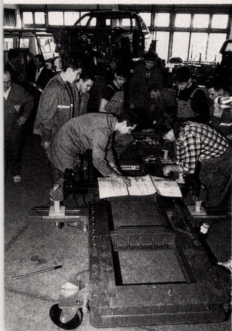
Példül a Blackhawk-húzópad. A Csonka János Műszaki Szakközép- és Szakmunkásképző iskola diákjai a német testvériskola hallgatóival karöltve állítják össze a berendezést
