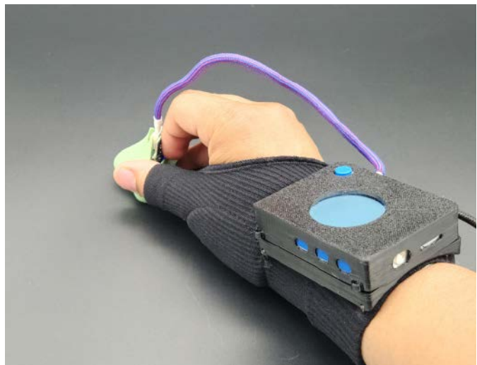
Fotografia 8. Moduł do wizualizacji zapachów z elektronicznym nosem
