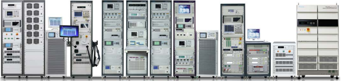
Fotografia 1. Największe systemy pomiarowe ATE są wykonywane w formie opracowywanych na zamówienie szaf rackowych, mieszczących całość osprzętu pomiarowego, sterującego, zasilającego, a często też przetwarzającego i archiwizującego dane ( https://t.ly/C7u0x )
