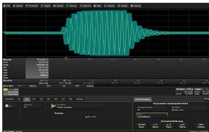
Rysunek 6. Zastosowanie funkcji pass/fail oscyloskopu do testowania obwiedni sygnału przetworników ultradźwiękowych ( https://t.ly/WiLO )
