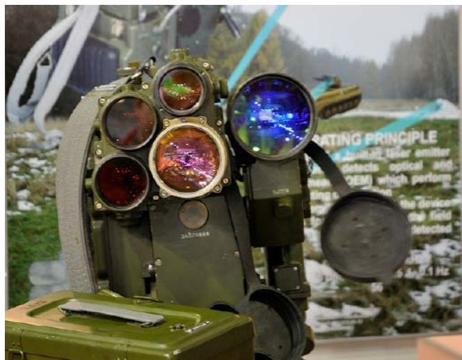
Fotografia 3. Przenośny system PAPV do neutralizacji urządzeń optoelektronicznych
