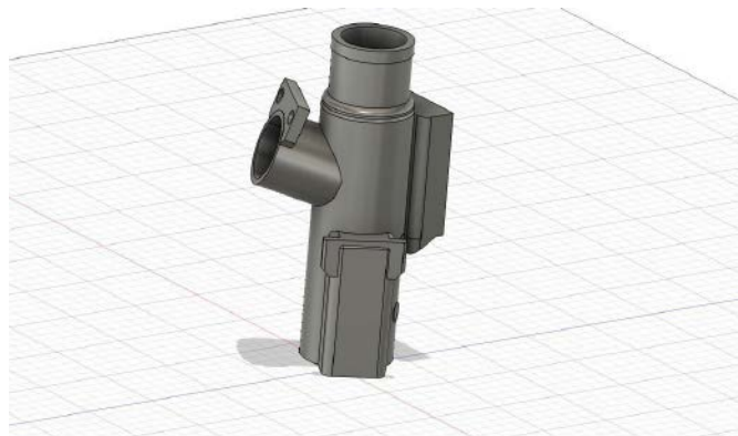
Rysunek 2. Układ pomiarowy z dyszą Venturiego i miejscami do osadzenia sensorów \text{O}_2 i \text{CO}_2
