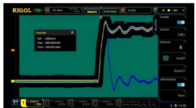
Rysunek 5. Ilustracja działania funkcji pass/fail w oscyloskopie z serii DS7000 marki Rigol. Warto zwrócić uwagę na barwną reprezentację statystyk przebiegu ( https://t.ly/iYz5F )
