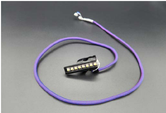
Fotografia 6. Moduł sensora i diod RGBW do noszenia na palcu podczas korzystania z urządzenia
