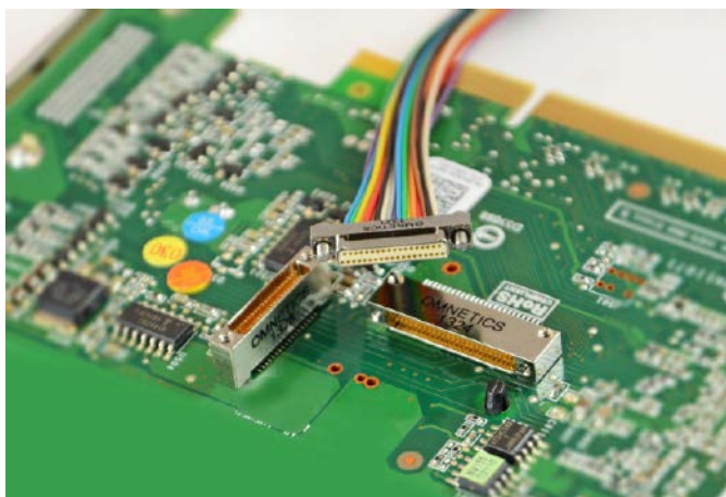
Fotografia 6. Gniazda typu MIL-DTL-32139 firmy Omnetics na PCB oraz wiązka kablowa z takim samym wtykiem tego samego producenta
