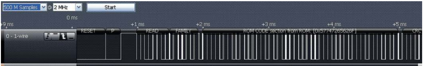
Rysunek 8. Rzeczywiste przebiegi sygnałów sterujących magistrali 1-Wire dla przypadku rozkazu READ_ROM wysłanego do naszego urządzenia DS18S20
