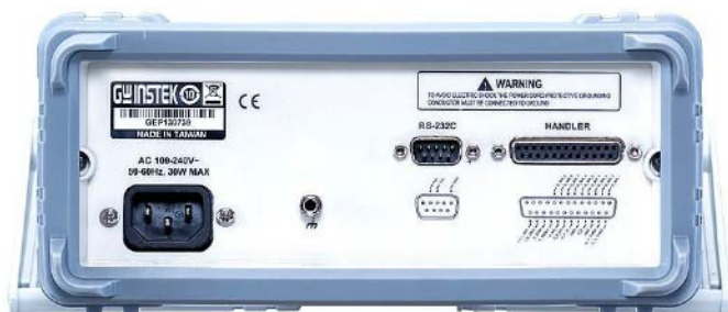
Fotografia 5. Panel tylny miernika z serii LCR-6000 marki GW Instek. Widoczne gniazdo RS-232C oraz złącze cyfrowych linii I/O (HANDLER). Źródło: https://t.ly/PkgJ
