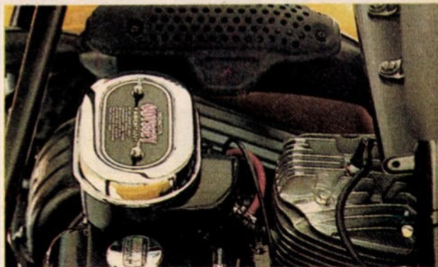
A 16,2 kW-os (22 lóerős) 250-es motor gondoskodik a Spunky mozgásáról. A magasra húzott kipufogódobot lyukasított védőlemez borítja.
