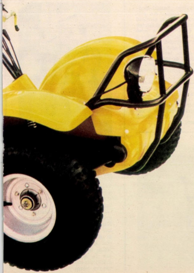
A 16,2 kW-os (22 lóerős) 250-es motor gondoskodik a Spunky mozgásáról. A magasra húzott kipufogódobot lyukasított védőlemez borítja.
