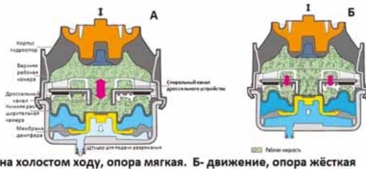
Схема работы гидроопоры с электронным управлением
