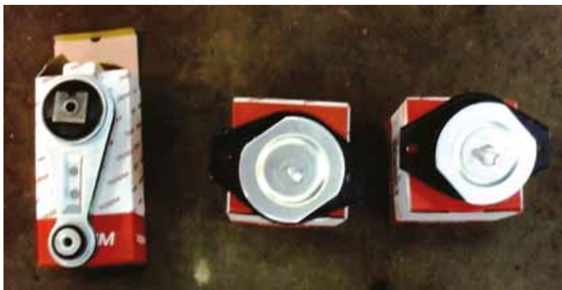
Резино-металлические опоры двигателя ВАЗ Лада 112 – просто и надежно
