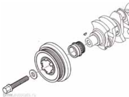
Схема установки демпфера крутильных колебаний
