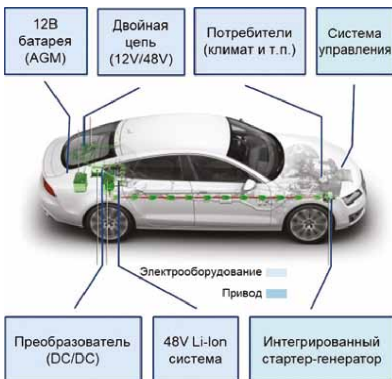
Рис. 2. Конструкция современного гибридного транспортного средства
