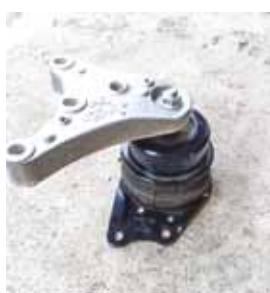
В резино-металлической опоре двигателя Skoda Fabia используется алюминиевый кронштейн
