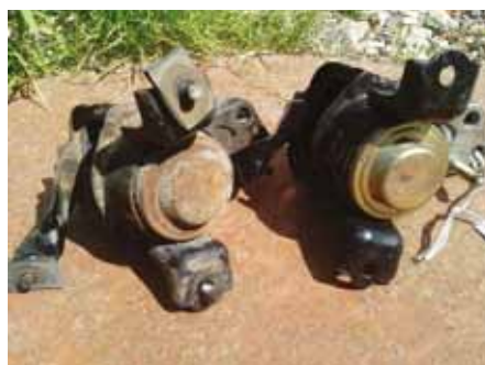
Гидроопоры с механическим регулированием для двигателя Toyota Corolla
