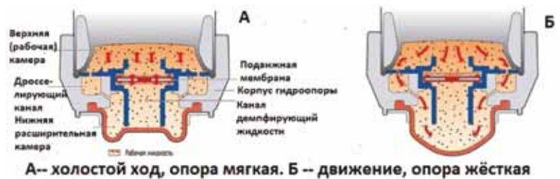
Схема работы гидроопоры с механическим регулированием
