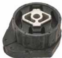
Коробка передач крепится в автомобиле также, как и двигатель, на резино-металлических опорах. На фото – опора для КПП BMW X3
