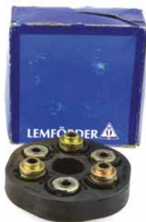
В корпус эластичной муфты установлены металлические втулки для болтов крепления
