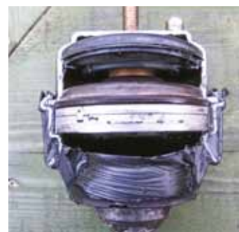
Электровакуумная гидроопора Volvo CX-90 в разрезе. В нижней камере гидромасло, средняя камера – перепускная, верхняя камера – камера разряжения
