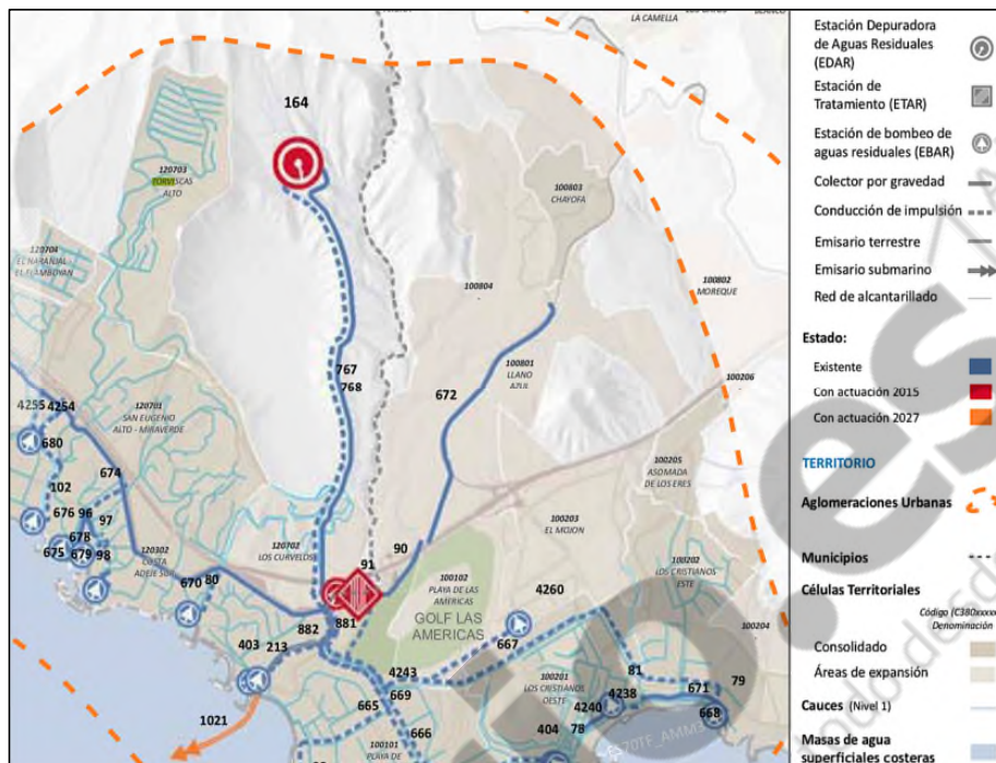
Ubicación de la EBAR Torviscas, de la Estación de Pretratamiento y Bombeo, y de la EDAR Adeje-Arona
