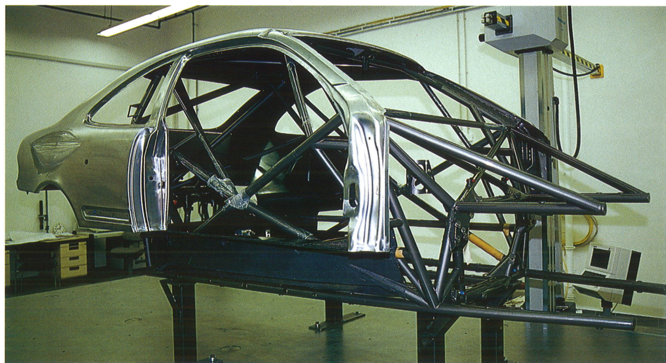
Volles Rohr: Die Blechteile sind mit dem Gitterrohrrahmen verschweißt – der Käfig wird als komplette Einheit bei HWA angeliefert
