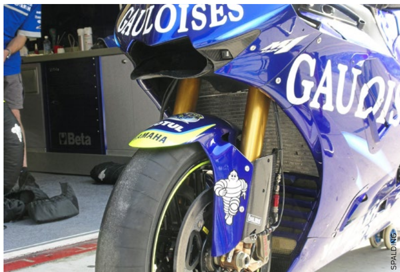
Für den Katar-GP kam eine Verkleidung für mehr Luft auf den größeren Kühler
