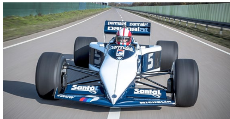
Ein Jahr lang war der Brabham BT52 außer Gefecht. Bei der Revision des legendären BMW-M12/13-Motors wurden keine größeren Schäden erkannt. Das Aggregat leistet trotz Turbo-Downgrade immer noch mehr als 600 PS
