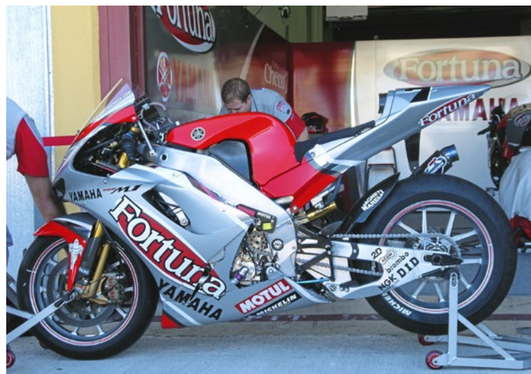
Valencia 2003: Langer Rahmenausleger und längere Unterzugschwinge
