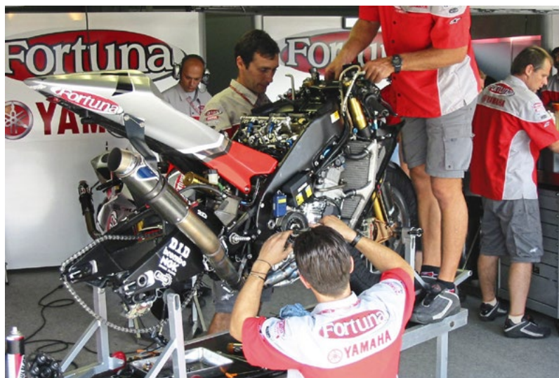
2003er-Yamaha M1 mit Motorhalterung am Zylinderkopf und kurzem Radstand
