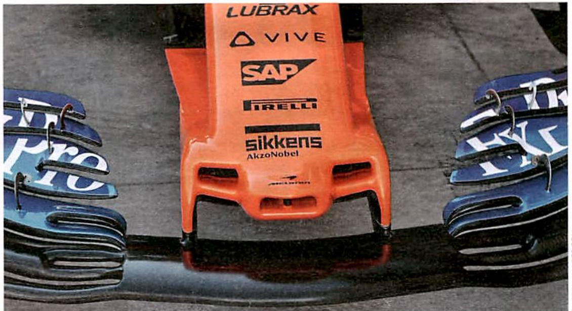
Die Nase des MCL33 wurde zweimal umgebaut. Zuerst auf drei Nasenlöcher, dann ohne Vertikalschiene
