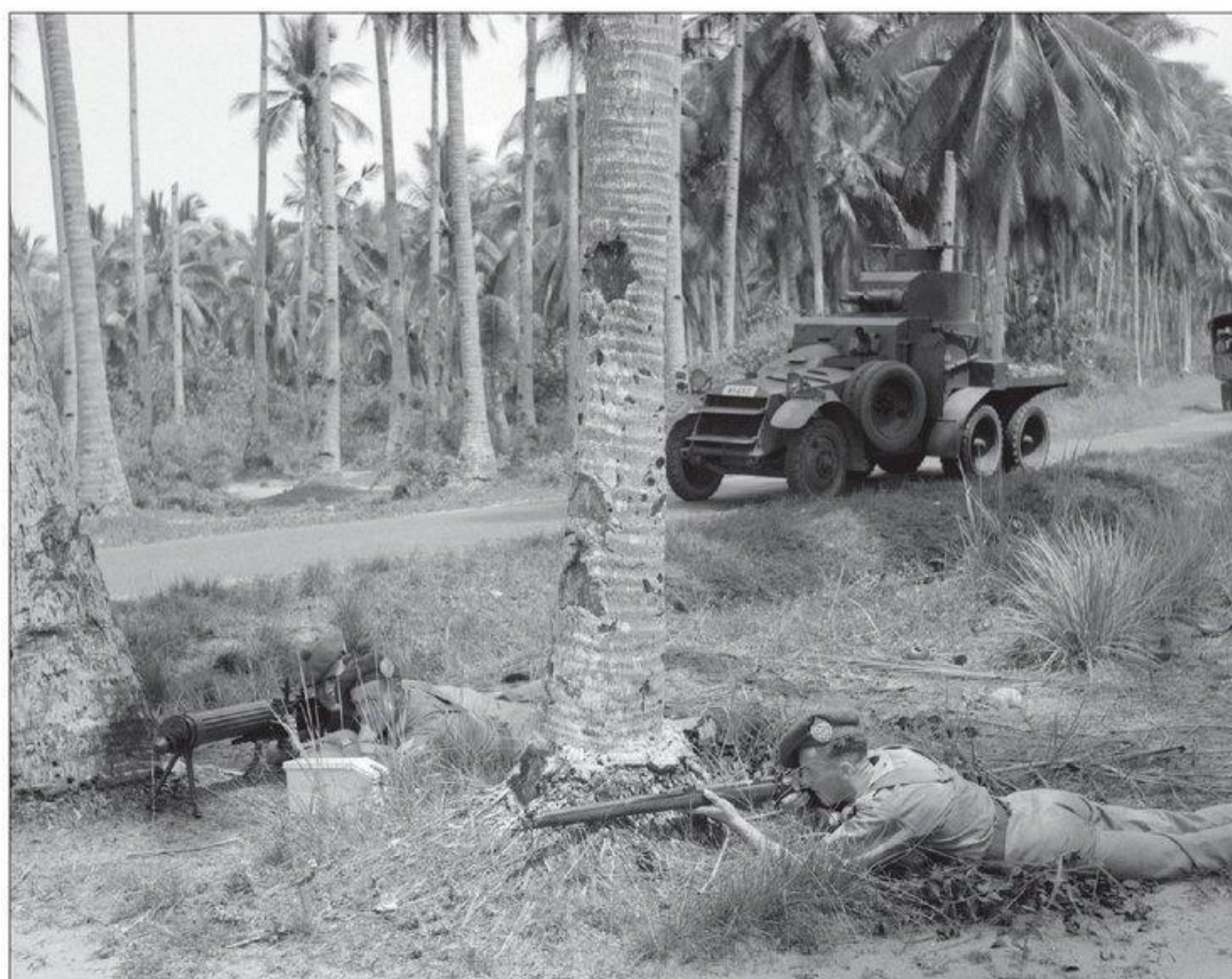
▲ Automitrailleuse Lanchester Mark III , reconnaissable à son double essieu arrière et son tourelleau cylindrique, stoppée à proximité d'une position tenue par des hommes du 2nd Argyll and Sutherland Highlanders , l'une des rares unités présentes dans la péninsule malaise à être équipées de blindés. Cette troupe d'élite sera surnommée the « Jungle Beast's » (les bêtes de la jungle). Malmenée par les Japonais, elle finira « amalgamée » avec d'autres troupes dans la souricière de Singapour...
