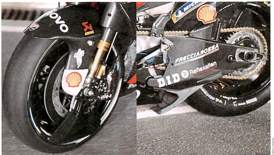
Letzter Geniestreich und Stein des Anstoßes: Aerodynamische Hilfen an der Gabel und der Hinterradschwinge
