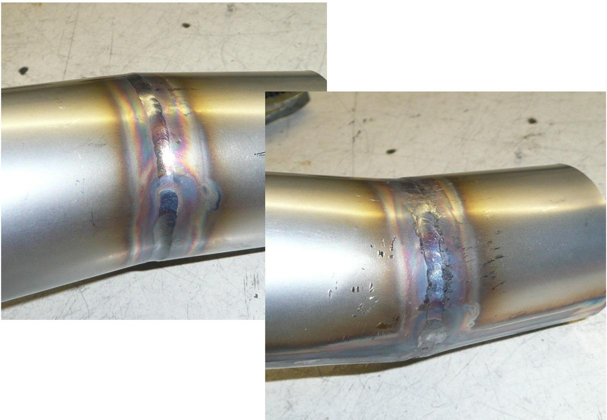
Bild 19 : Fertige Schweißnaht vor/nach dem Hämmern
