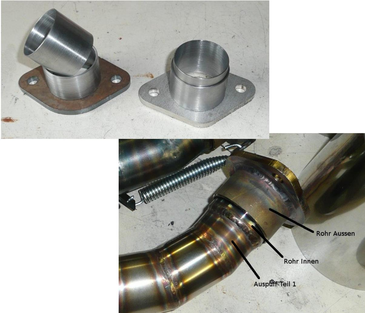
Bild 21 : Zylinderflansche
