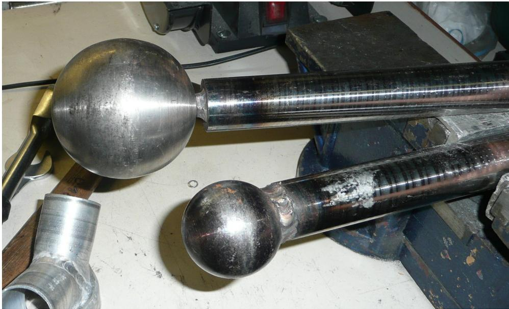
Bild 18 : „Zepter“ zum Hämmern der umlaufenden Nähte
