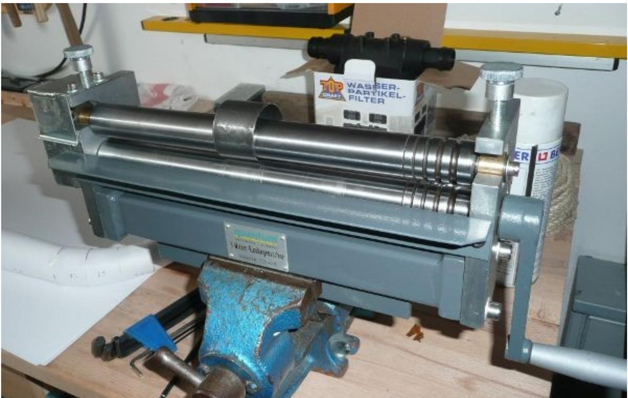
Bild 11 : Rollenbiegemaschine
