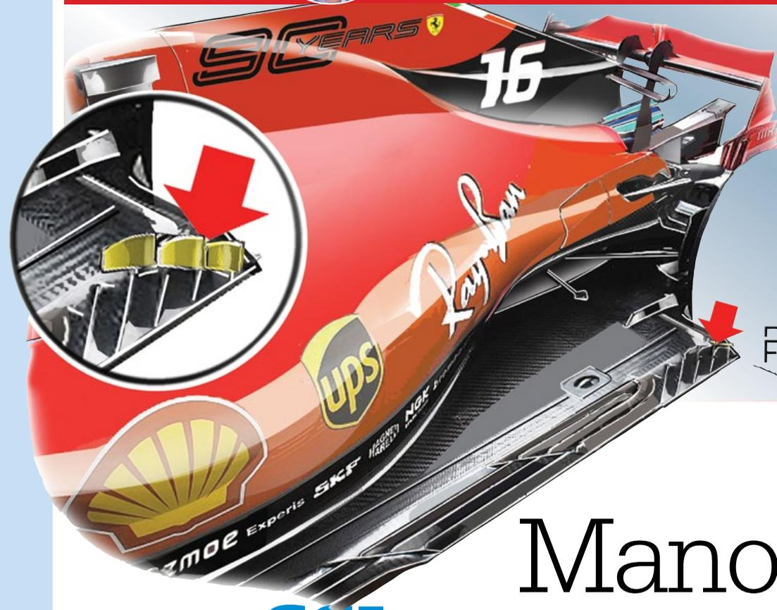
IL FONDO PORTATO IN AUSTRALIA ERA LA VERSIONE PROVATA A BARCELONA, RIVEDUTA E CORRETTA. IN PRATICA SONO STATI ELIMINATI I FLAP VERTICALI DAVANTI ALLE RUOTE POSTERIORI, CHE AVREBBERO POTUTO DETERMINARE L'ACCUMULO DI MARBLE DI GOMME E FRAMMENTI DI FOGLIE, CREANDO UN BLOCCAGGIO NELLA ZONA LIMITROFA AI CANALI LATERALI DEL DIFFUSORE, RIDUCENDONE L'EFFICIENZA.
