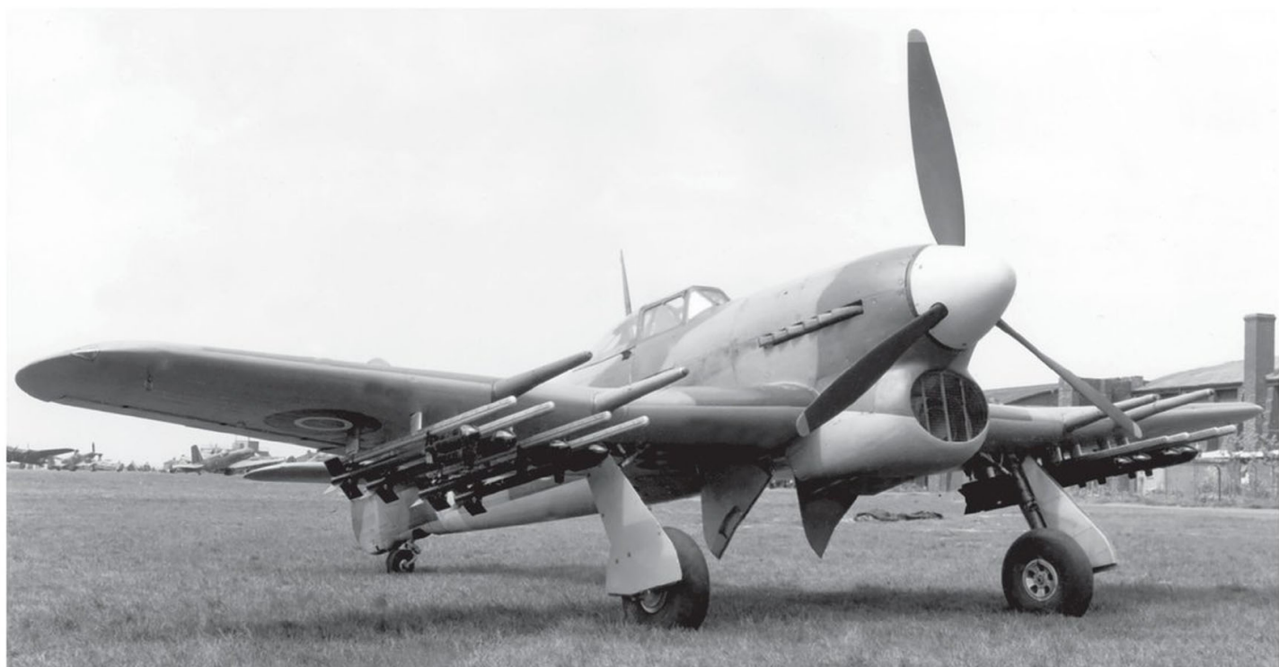
▼ EK497, le premier Typhoon à être équipé de roquettes, photographié pendant les essais officiels à l' Aircraft and Armament Experimental Establishment de Boscombe Down, en août 1943. (Coll. A. Thomas)
