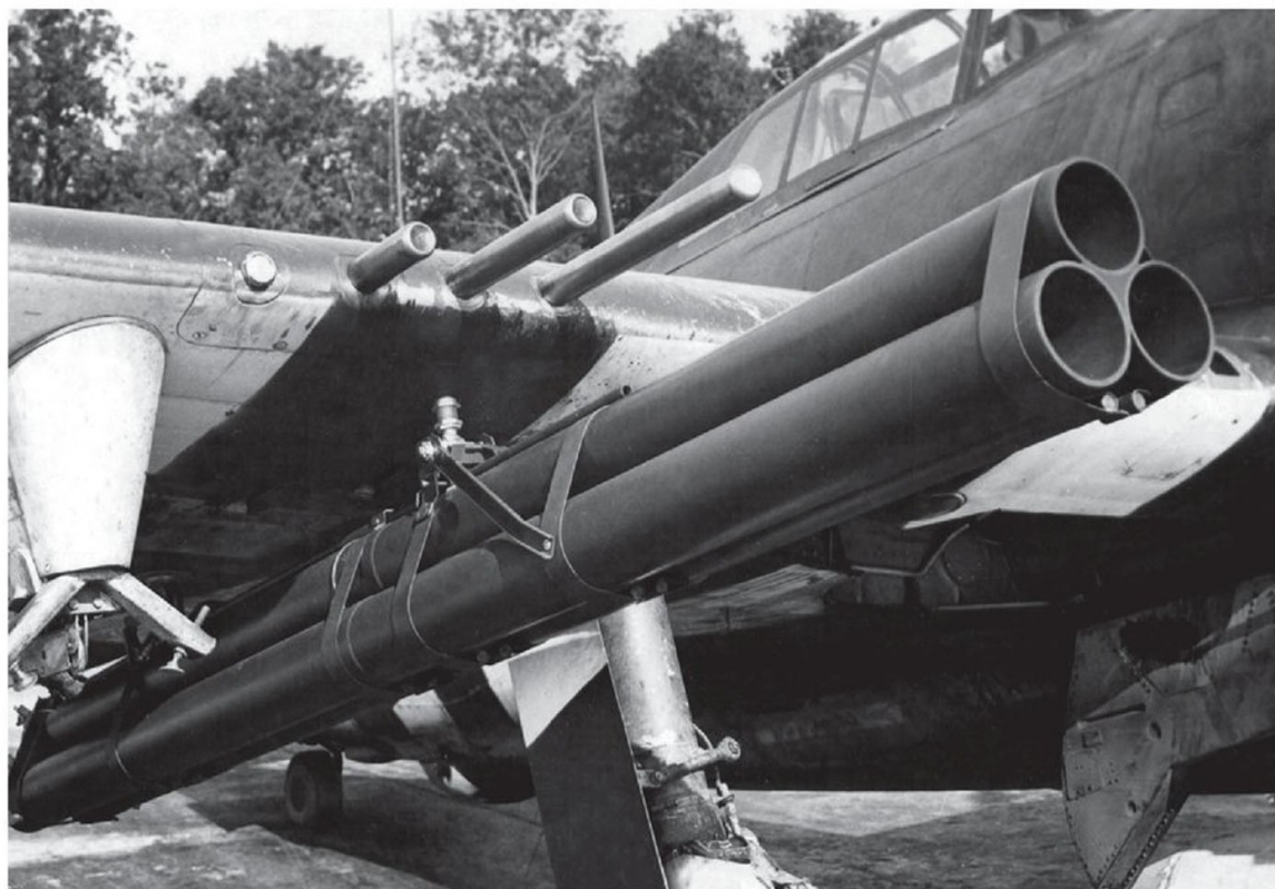
◀ Gros plan sur le M10 Triple Tube Rocket Launcher de 4,5 inch (114 mm) tardivement monté sous les ailes de quelques P-47 Thunderbolt de la 9th Air Force en 1944. Il s'agit d'un dérivé, réduit à trois tubes, du lance-roquettes multiple Calliope tirant des fusées M8 et que l'on retrouve sur certains chars Sherman à la fin de la guerre. Guère convaincant, ce dispositif cède la place à la roquette HVAR (High Velocity Aircraft Rocket). (USAF)
