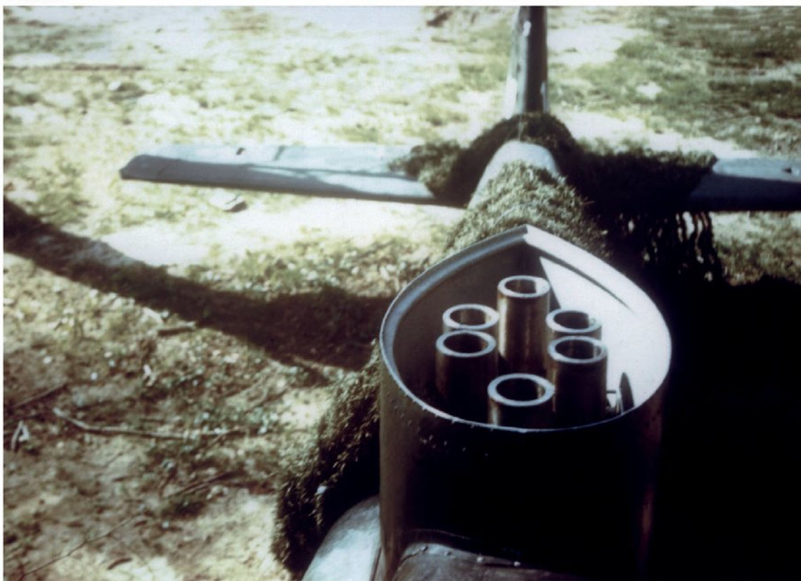
◀ L'arme antichar SG 113 A Förster sonde (SG pour Sondergerät ou équipement spécial) montée, à raison de six canons sans recul de 77 mm, au milieu du fuselage d'un Hs 129 B-0 muni, sous le nez, d'une perche de détection à cellule photoélectrique. (E-N Archives)
