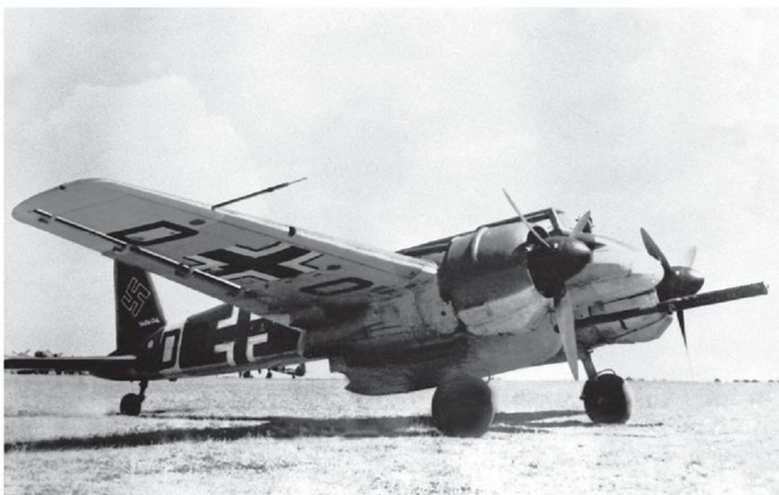
▲ Un Henschel Hs 129 B-2 modifié au standard B-3 à canon BK 7,5 (il lui manque encore le viseur ZFR 3 B). On notera que les MG 151/20 et MG 17 ont été retirés pour gagner en poids et que leurs goulottes ont été obstruées. (ww2images)
