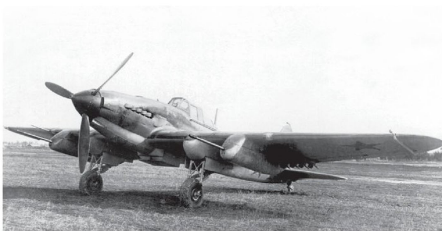
▲ Ci-dessus : Un Iliouchine Il-2 Chtourmovik à moteur AM-38 armé de canons ChFK de 30 mm lors des essais officiels en 1941. (Coll. O. Rastrenin)
