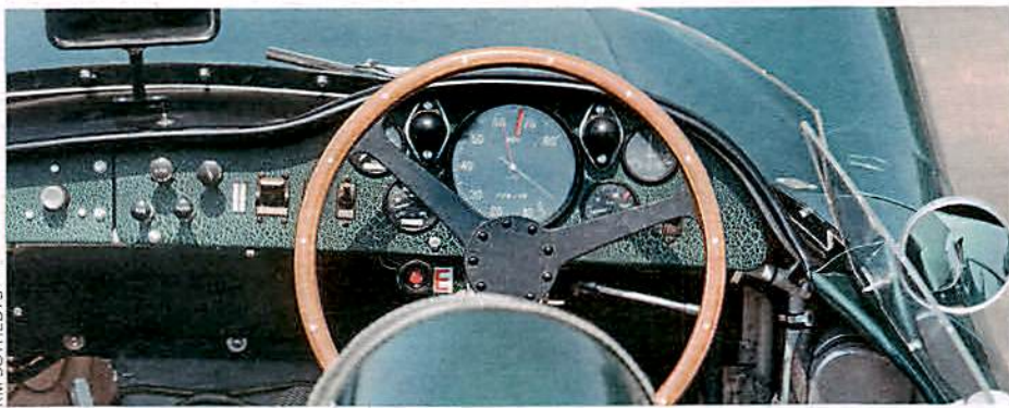
Funktionelles Cockpit des DBR1/300 mit zentralem Drehzahlmesser
