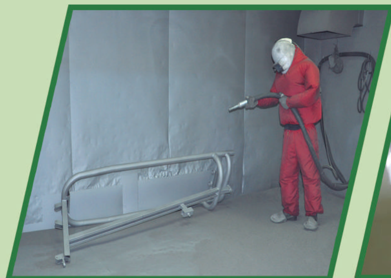
Jato de Granalha
