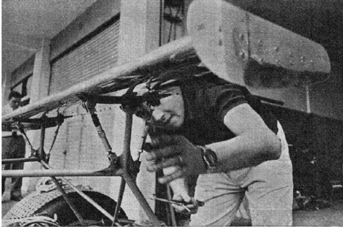
Tecno, en cambio, usó un alerón fijado al chasis y al motor. Nótese los tensores mediante los que se regula la inclinación del alerón.
