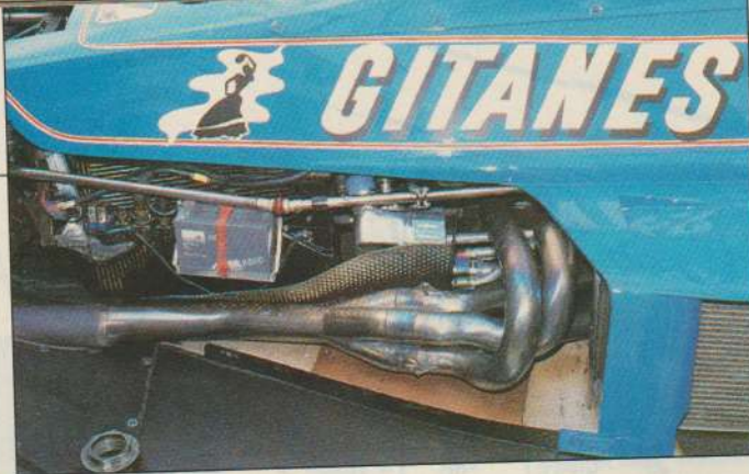
La Ligier era modificata nelle pance laterali: si sono viste quelle corte che lasciavano i serbatoi laterali scoperti e quelle che denudavano invece la parte posteriore (Photo4)
