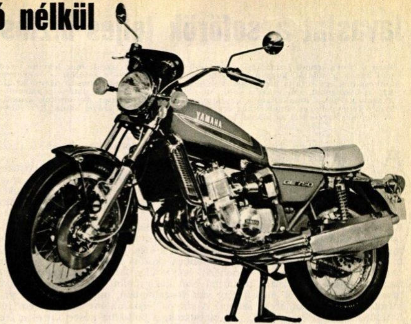
Ezzel a modellel a Yamaha is felzárkózott a Honda, Kawasaki, Suzuki 750-es családokhoz. A képről ítélve, ez a Yamaha nem tűnik szélesnek, ámbar soros négyhengeres motorja keresztben áll. Igaz, az „elektromos gyárat” levették a főtegeléről, és hátrább tették. A két-két kipufogócső közös dobba torkollik, akárcsak a négy szívócső is közös szívás-zajesőkkentő edénybe végződik. A mellő kerék mindkét oldalán egy-egy tárcsafék nyeli el az energiát...
