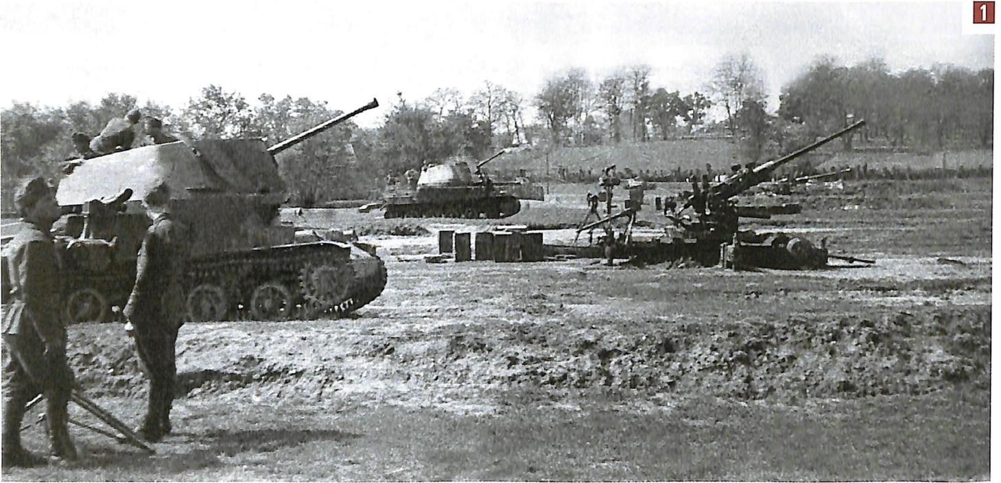
L'armement se compose d'une pièce de 40 mm, le 36M, dont la licence a été achetée auprès de la société suédoise Bofors. Long de 60 calibres (2,40 mètres), son tube autorise une vitesse initiale de 881 m/s et une cadence de tir de 120 coups par minute. La dotation en munitions s'élève à 160 obus répartis sur quatre lames-chargeurs.
