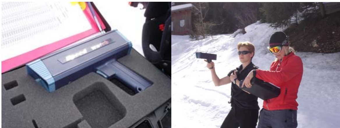
Abb. 4: Radarpistole und Radarmessung auf der Skipiste
