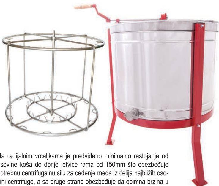
Na radijalnim vrcaljkama je predviđeno minimalno rastojanje od osovine koša do donje letvice rama od 150mm što obezbeđuje potrebnu centrifugalnu silu za ceđenje meda iz čelija najbližih osovini centrifuge, a sa druge strane obezbeđuje da obimna brzina u zoni satonoša nije prevelika.
