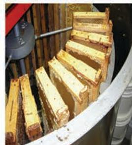
Električne radijalne vrcaljke mogu biti poluautomatske ili automatske i predviđene su da se napajaju sa izvora od 12V i 220V odnosno samo sa 220V. Kod poluautomatskih vrcaljki korisnik u toku rada određuje brzinu okretanja rotora i opcionalno vreme vrcanja dok kod potpuno automatskih vrcaljki, kompletan proces vrcanja i regulacije se obavlja preko integrisanog kontrolera prema unapred zadatim parametrima rada.
