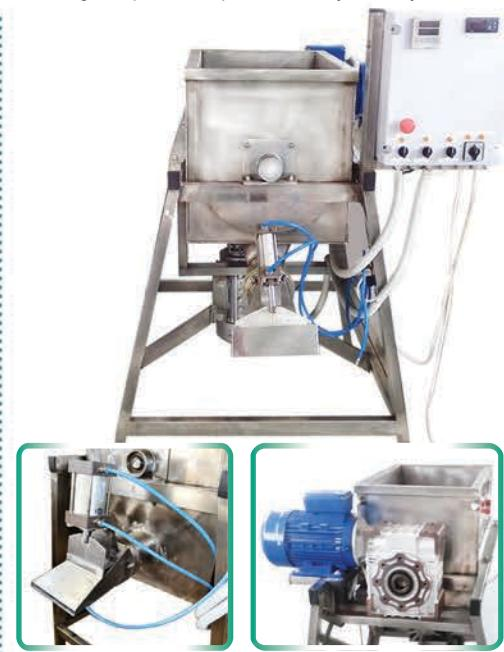
**1152 Mešač za pogače – horizontalni, sa automatskim dozerom u kese, 100L, automatski**
